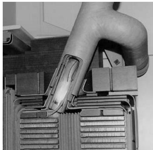
Bild 7.1.3-7: Anschluss eines 220 kV-Ausleitungssystems aus konzentrischen Barrieren an die Wicklungen eines Autotransformators, vgl. Bild 7.1.3-4b. Werkbild des Schnittmodells: Fa. Weidmann, Rapperswil (CH).
