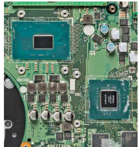
Im Asus GL553VD kommen sowohl der neue Intel Core i7-7700HQ (oben links) als auch der neue Nvidia GeForce GTX 1050 (unten rechts) zum Einsatz.
