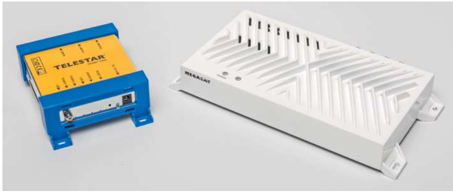
Der Sat-IP-Server Telestar Digibit Twin mit zwei Tunern (links) ist mit 80 Euro günstiger als zwei herkömmliche DVB-S2-Adapter. Der Megasat MEG-8000 Server 3 (rechts) bietet sogar 8 Tuner und kostet 150 Euro.
