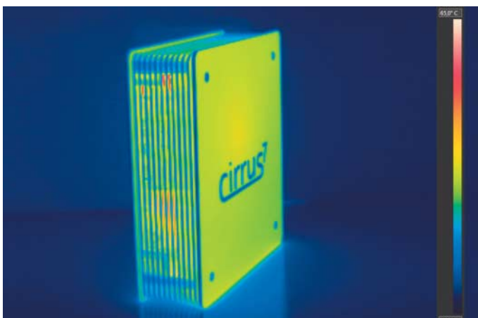
Vorbildlich: Die Gehäuseseiten des Cirrus7 Nimbus werden selbst unter anhaltender Volllast nur handwarm.
