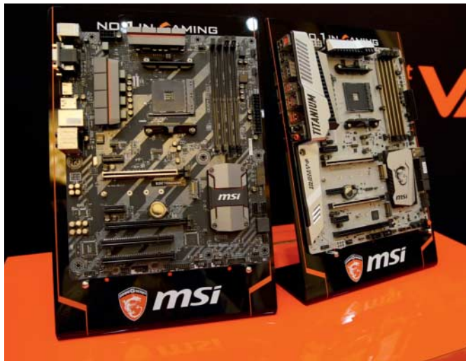
AM4-Mainboards von MSI mit AMD B350 und X370: B350 Tomahawk und X370 Xpower Gaming Titanium
