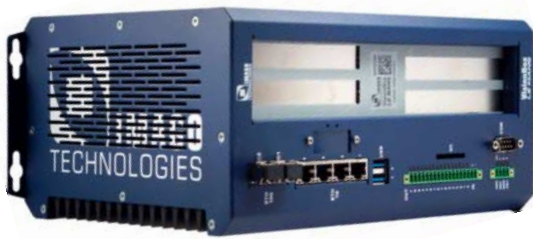
Ein ARM im Industriekleid: Die Visionbox „Le Mans“ ist ein speziell für Bildverarbeitung entwickelter Industrierechner.
