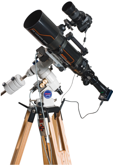
Hier ist eine Kamera huckepack auf einem Fernrohr montiert, das dank angeschlossenem Autoguider als Leitfernrohr fungiert.
