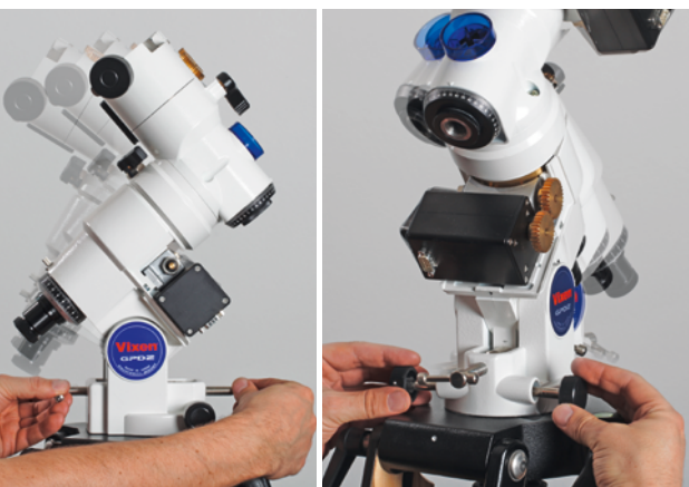
Justageschrauben ermöglichen die Einstellung von Polhöhe (links) und Azimut (rechts).
