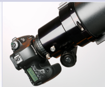
3. Die Kamera mit Adapter am Fernrohr (statt Okular)
