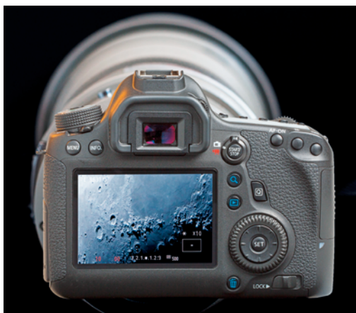
Die Live-View-Funktion ermöglicht die Anzeige eines stark vergrößerten Bildausschnitts.
