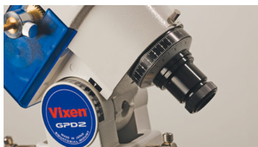
In die Stundenachse mancher Montierungen lässt sich ein Polsucherfernrohr einsetzen.
