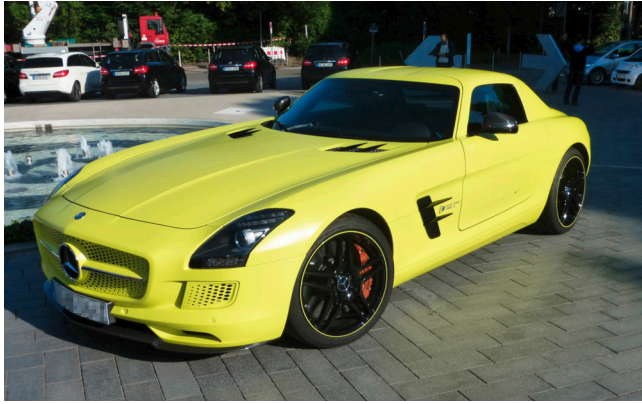
Bild 5.8 Beispiel für die Konstruktion mit vier radnahen Elektromotoren: SLS AMG Electric Drive (Leistung 552 kW!)
