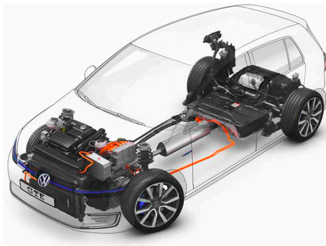
Bild 3.3 Beispiel eines Plug-In-Hybrids, Golf GTE. Vorne links der Verbrennungsmotor, rechts der Elektromotor. Quelle: Volkswagen Aktiengesellschaft
