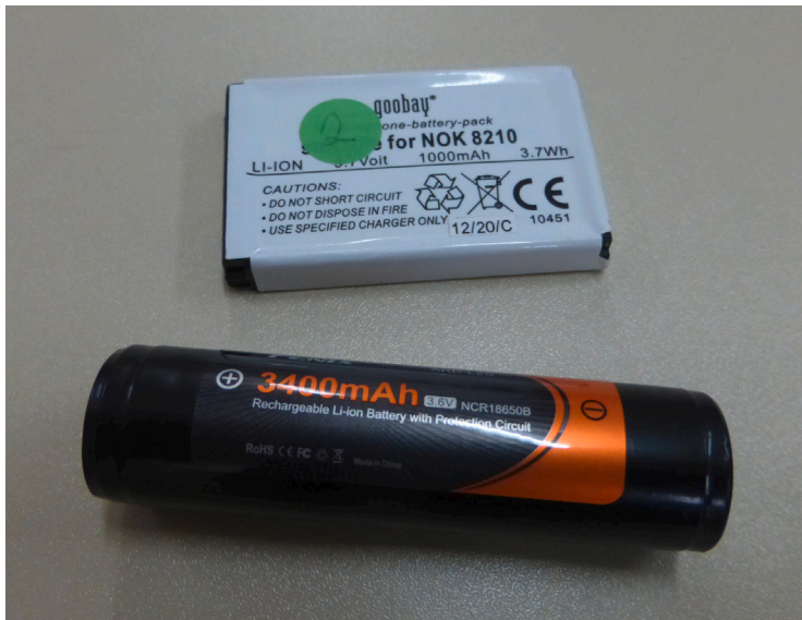
Bild 5.14 Herkömmliche Li-Ionen-Akkus. Runde und prismatische Form
