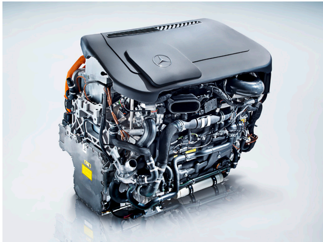
Bild 3.9 Das aktuelle Entwicklungsstadium (2014) des Daimler Brennstoffzellenantriebs. Quelle: Daimler AG
