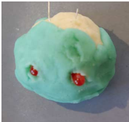
Beim Umhüllen mit leitfähiger Knete bleiben die Anoden frei. Zwischen Kathoden und Augen darf die Hülle dicker sein.
