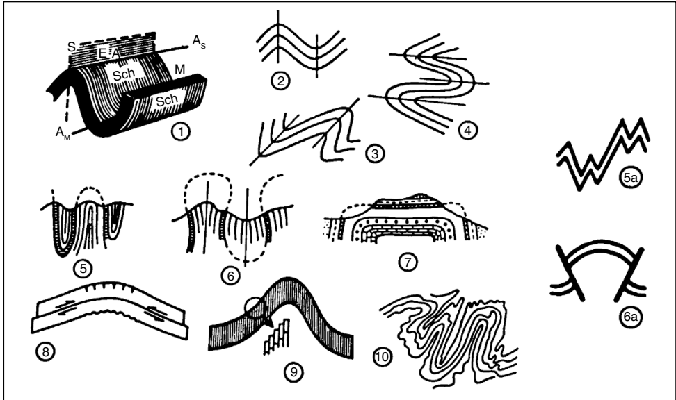
Abb. 25a Schematische Darstellung von Faltenarten: 1 Anatomie einer Falte (S Sattel, M Mulde, Sch Falten-schapel, A_M Muldenachse, A_S Sattellachse, E_A Achsebene); 2 stehende Falte; 3 überkippte Falte; 4 liegende Falte; 5 Isoklinale Falte; 5a Zickzackfalte; 6 Fächerfalte; 6a Pilzfalte; 7 Kofferfalte; 8 Schema einer Biege- (Knick-)Falte; 9 Schema einer Scherfalte; 10 Fließfalte.
