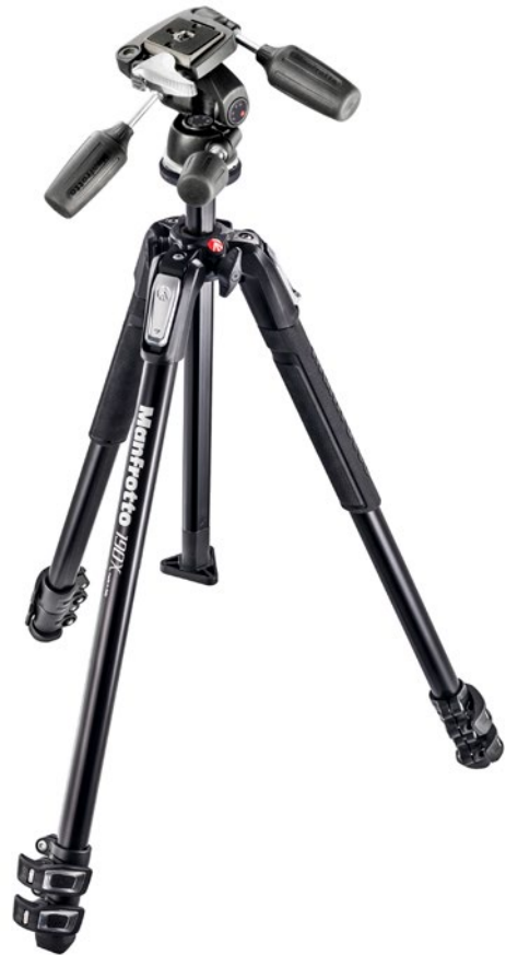
▲ Manfrotto-Stativ der 190er-Serie mit drei Segmenten pro Stativbein und einem Dreiwegeneiger als Stativkopf. Aufgrund der verringerten Anzahl der Segmente pro Stativbein steht das Stativ noch stabiler auf dem Boden.
