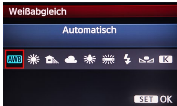
▲ Der automatische Weißabgleich ist im Kameramenü gekennzeichnet durch die Buchstabenkombination AWB (Automatic White Balance).
