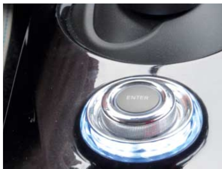
Der Multifunktionsknopf für die Bedienung des Infotainmentsystems ist in der Mittelkonsole untergebracht.
