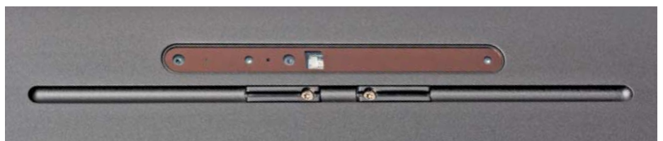
Auf der Rückseite der MobileStudio-Geräte mit maximaler Ausstattung sitzt eine 3D-Kamera von Intel, die RealSense R200. Damit lassen sich freihändig 3D-Scans anfertigen.
