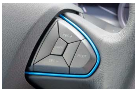
Über eine Taste am Lenkrad startet man den pilotierten Fahrmodus.
