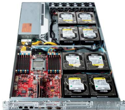
Windows Server auf ARM: In diesem „Project Olympus“-Einschub steckt der Qualcomm Centriq 2400.
