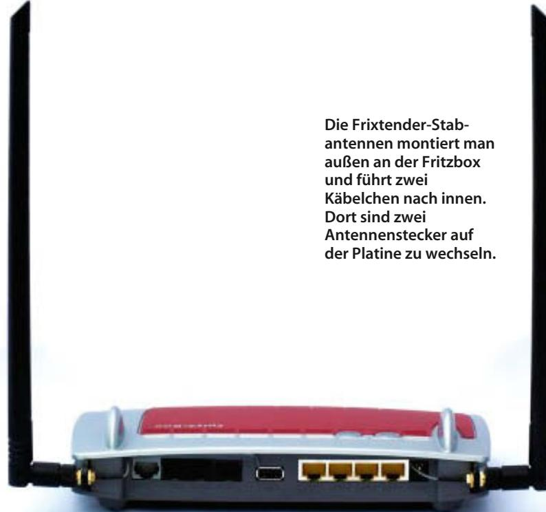
**Die Frixtender-Stabantennen montiert man außen an der Fritzbox und führt zwei Kabelchen nach innen. Dort sind zwei Antennenstecker auf der Platine zu wechseln.**
