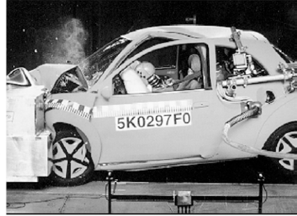
Bild 1-25: Auslösen eines Airbags in einem PKW
