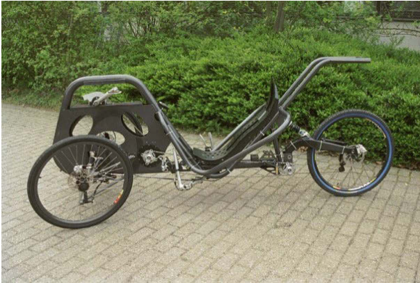
Bild 9-72: Rahmenaufbau des VIRAGETTE-Neigefahrrads
