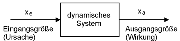
Bild 1-10: Blockschaltbilddarstellung eines Systems
