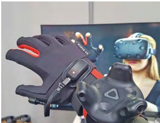
Der Datenhandschuh „Manus VR“ orientiert sich mit Hilfe eines Vive-Trackers im Raum.
