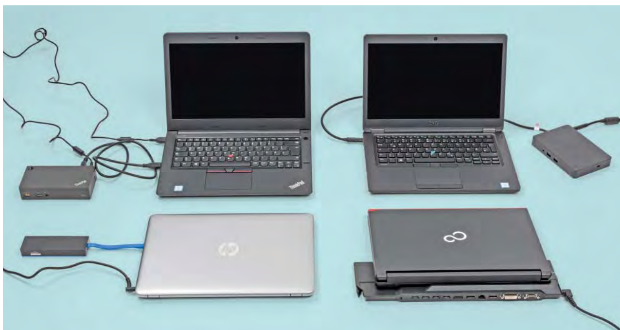
Generische USB-Docks wie bei Lenovo (hinten links) verschlimmern den Kabelsalat auf dem Schreibtisch; auch beim kompakten MiniDock von HP (vorne links) muss das Stromkabel extra angeschlossen werden. Dell (hinten rechts) nutzt die Typ-C-Verbindung auch für Strom – und Fujitsu (vorne rechts) hat ein klassisches Dock, in das das Notebook von oben eingesetzt wird.
