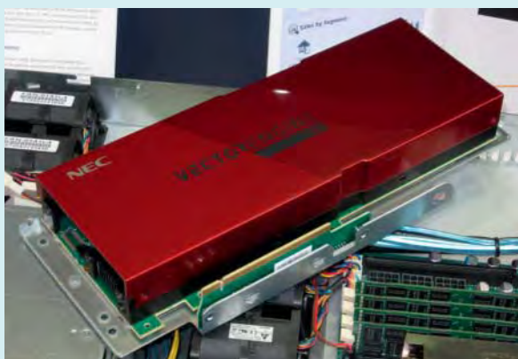
NECs Vektorprozessor Aurora läuft mit eigenem Linux und eigenem HBM2-Speicher in der PCIe-Steckkarte, das Gastsystem sorgt nur für Storage und Interconnect.
