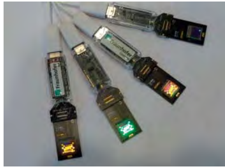
Das Fraunhofer FEP entwickelt Displays, in denen die Sensorik zum Erfassen der Augenbewegung integriert ist.
