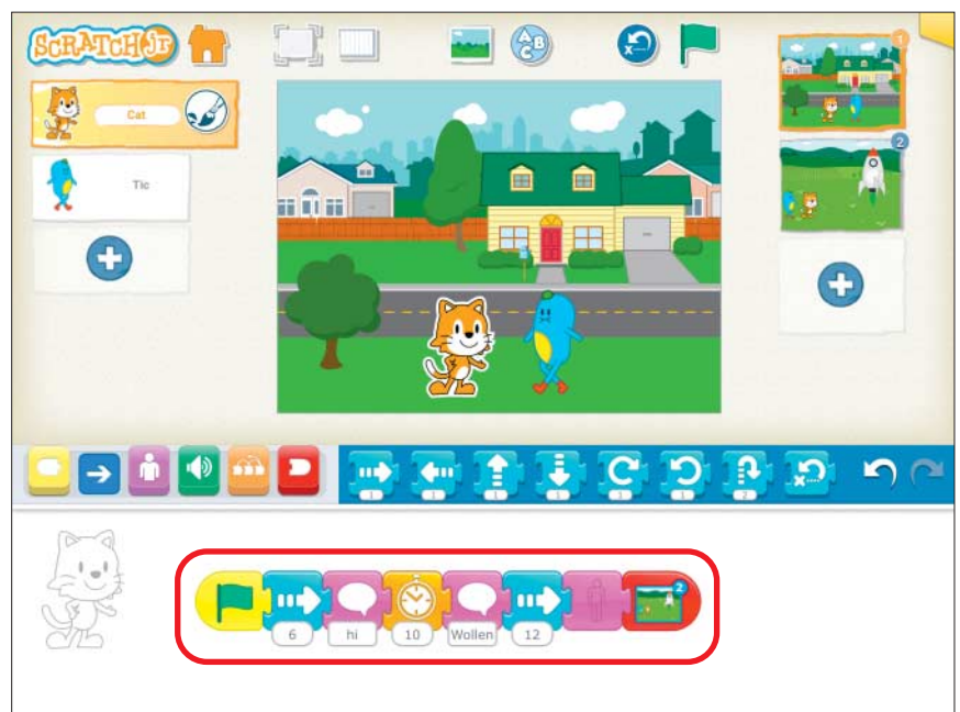
Die Bedienoberfläche von ScratchJr ist klar strukturiert. Das Herzstück bildet der Editor am unteren Bildrand. In der roten Umrandung befindet sich ein vollständiges Skript.
