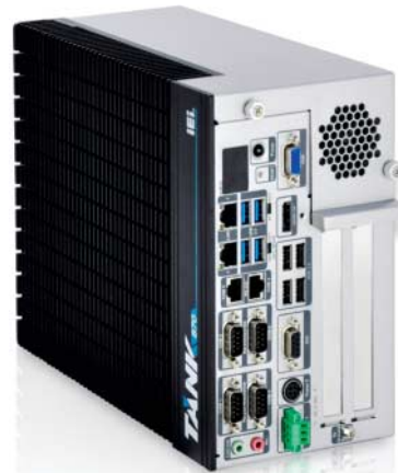
Der IEI ICP TANK-870-Q170i ist ein Industrie-PC vor allem für die Bildverarbeitung.
