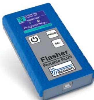
Der Segger Flasher Portable Plus ist ein JTAG-Programmiergerät mit Akku, das acht Firmware-Images vorhält.
