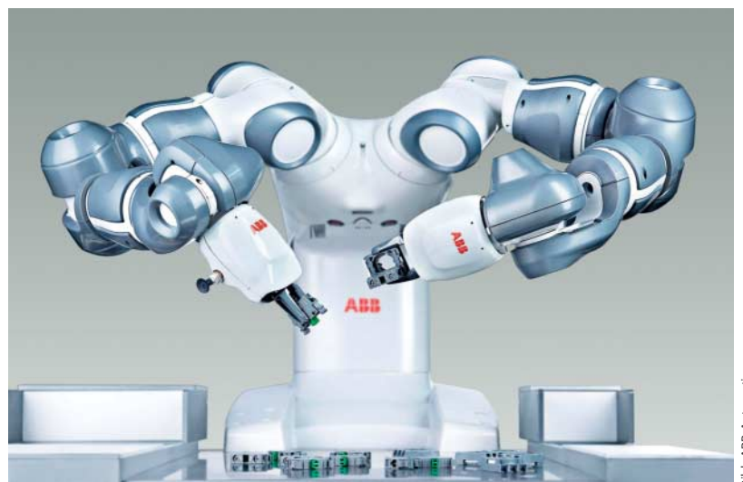
YuMi ist ein Zweiarm-Cobot von ABB Automation, der insbesondere für die Kleinteilmontage in der Elektronikindustrie konzipiert wurde.
