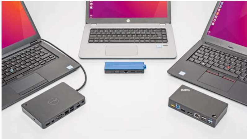
Die Display-Anschlüsse der Docking-Stationen von HP und Lenovo erfordern einen proprietären Treiber; das Dock von Dell funktioniert auf Anhieb.
