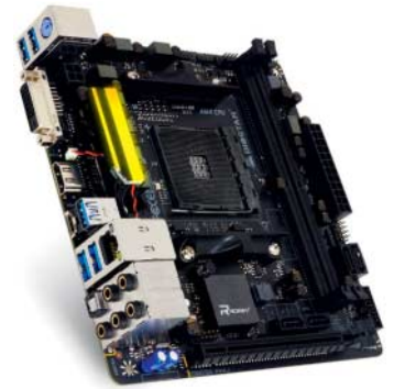
Mini-ITX-Boards wie das Biostar Racing X370GTN machen Ryzen-Prozessoren für kompakte PC-Gehäuse tauglich.
