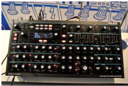
Der Novation Peak kombiniert Wavetable-Oszillatoren mit analoger Filterung zu einem achttimmigen Desktop-Synthesizer.
