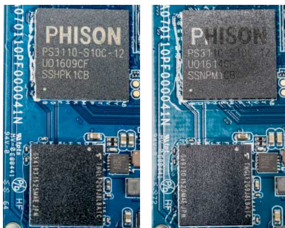
Zweieiige Zwillinge: Bei augenscheinlich gleichem Platinen-Layout besitzen die Goodram-SSDs unterschiedliche Controller und Flash-Chips.
