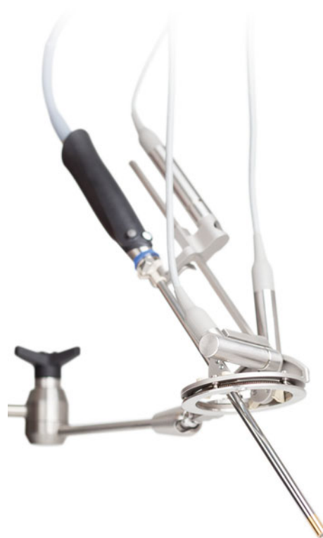
Abb. 6 Assistenzsystem ViKY der Firma ENDOCONTROL zum Halten und Führen von Endoskopen und Instrumenten
