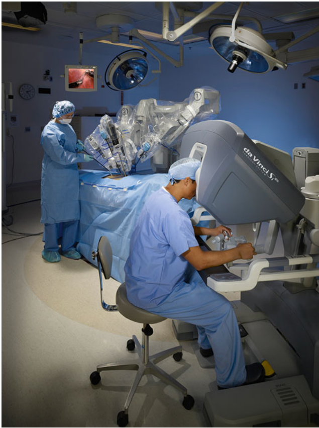
Abb. 2 Eingabekonzole (Vordergrund) und Teleoperator (am OP-Tisch) des da Vinci Xi-Systems von Intuitive Surgical, Inc. Die Blickrichtung des Chirurgen ist auf seine Hände gerichtet, er sieht jedoch das endoskopische Bild
