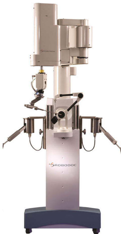
Abb. 5 ROBODOC, der Fa. CUREXO Technology Corporation, USA, Operationsroboter für die Orthochirurgie, jetzt TCAT der Fa. Think Surgical, Inc., USA (Copyright CUREXO Technology Corporation, mit Genehmigung)
