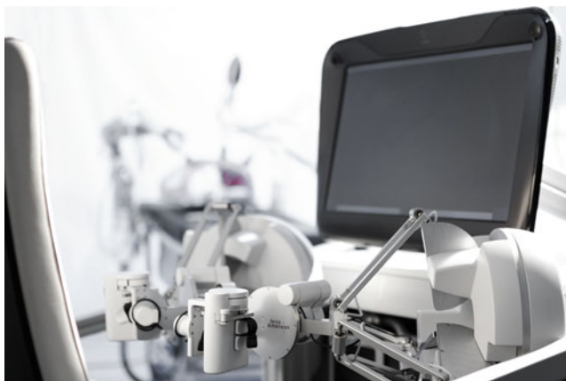
Abb. 10 Eingabestation des DLR MiroSurge-Systems mit 3D-HD-Monitor und Eingabegeräten für rechte und linke Hand mit je sieben aktiven Freiheitsgraden zur Rückkopplung von Interaktionskräften/-momenten aus dem Operationsfeld. (Bild: Deutsches Zentrum für Luft- und Raumfahrt e.V.)
