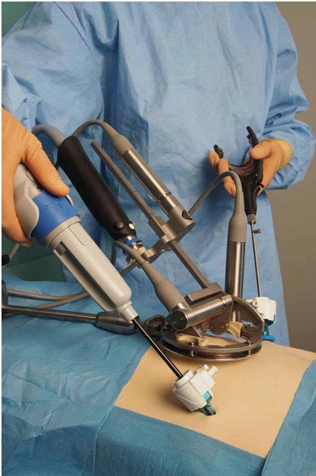
Abb. 7 Assistenzsystem ViKY der Firma ENDOCONTROL. Durch das kompakte Design ist der Patient für den Operateur gut zugänglich
