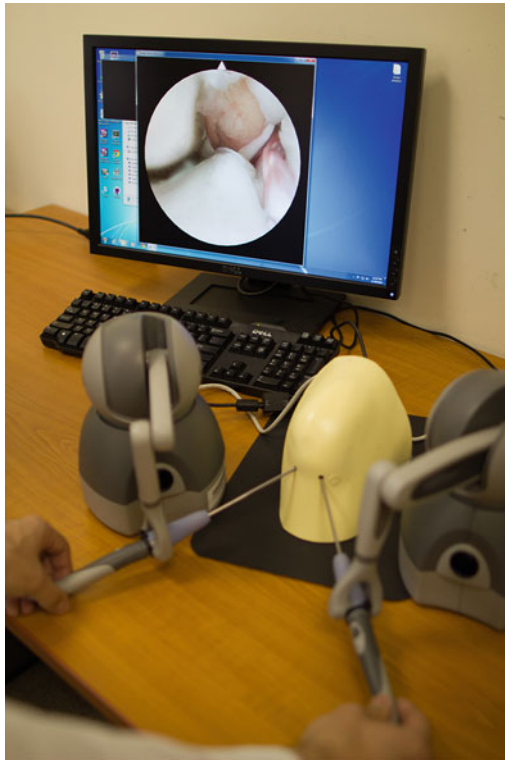
Abb. 7 Haptische Simulation bei einer VR-basierten Kniearthroskopie (Rasool et al. 2014)
