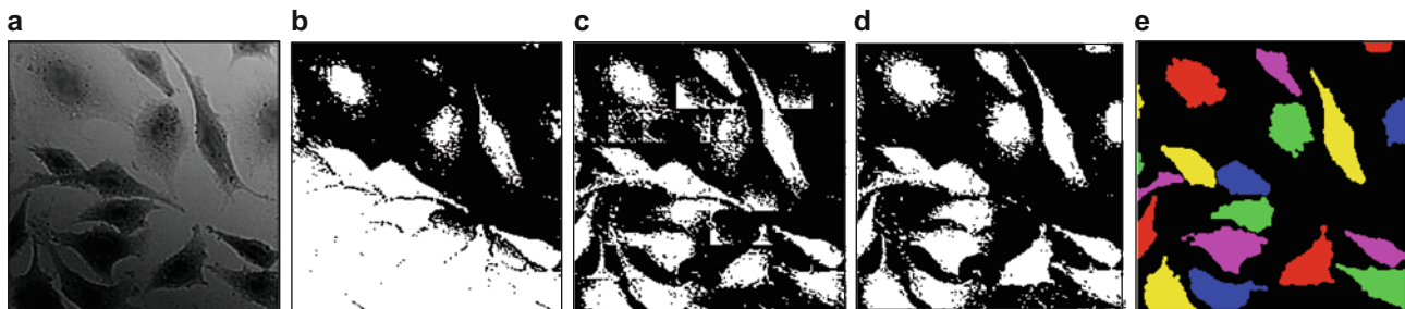
Abb. 11 Dynamische Schwellwertsegmentierung. a Die Mikroskopie einer Zellkultur wurde b global, c lokal adaptiv und d pixeladaptiv segmentiert. Nach morphologischer Nachbearbeitung zur Rauschunter-
