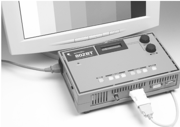
Bild 13.3 Videogenerator zur Erzeugung von Testbildern (Foto: Quantum)
