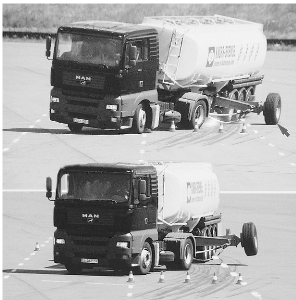
Bild 18.1 Ein elektronisches Fahrstabilitätssystem (unten) verbessert die Stabilität in kritischen Fahrsituationen (Foto: Knorr-Bremse)
