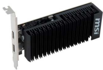
Von der GeForce GT 1030 gibt es auch lüfterlose Kompaktvarianten, etwa die MSI GeForce GT 1030 2GH LP OC.
