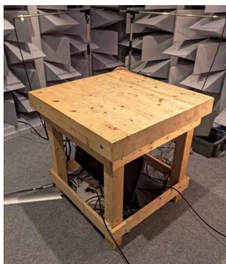
Die dicke Platte des Messtisches schwingt bei Vibrationen des Testgeräts nicht mit.
