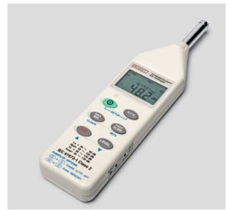
Hand-Schallpegelmesser der Klasse 2 messen unterhalb von 30 dBA nicht mehr genau.
