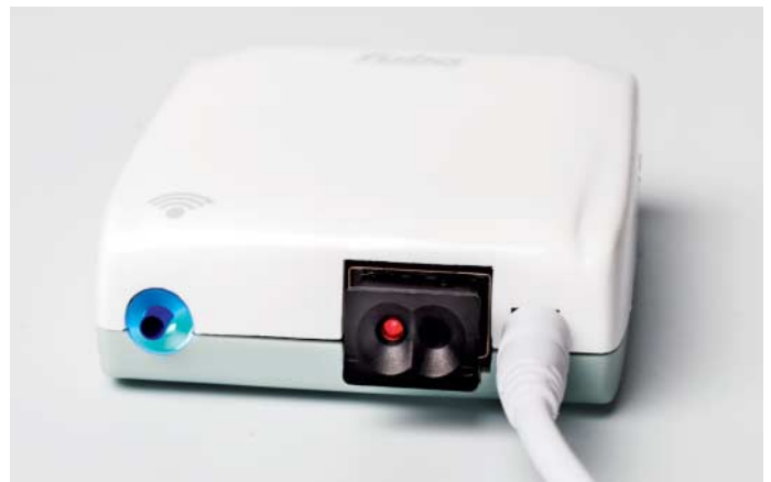
Ein kleiner Taster am WebFiber 1135 aktiviert die integrierte WLAN-Basis.
