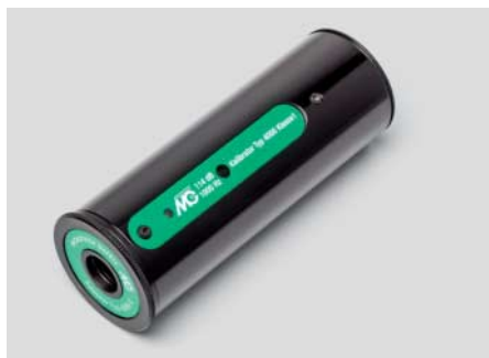
Der Kalibrator erzeugt einen 1-kHz-Sinuston mit 114 dB Pegel; man setzt ihn vor der Messung auf die Mikrofone.
