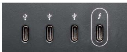
Am markierten Thunderbolt-3-Port nimmt das 5K-Display Video- und USB-Daten an und stellt Energie bereit.
