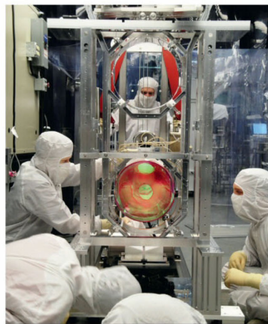
Eine komplexe Aufhängung schirmt die empfindliche Optik des LIGO-Detektors (M.) von Erschütterungen ab
