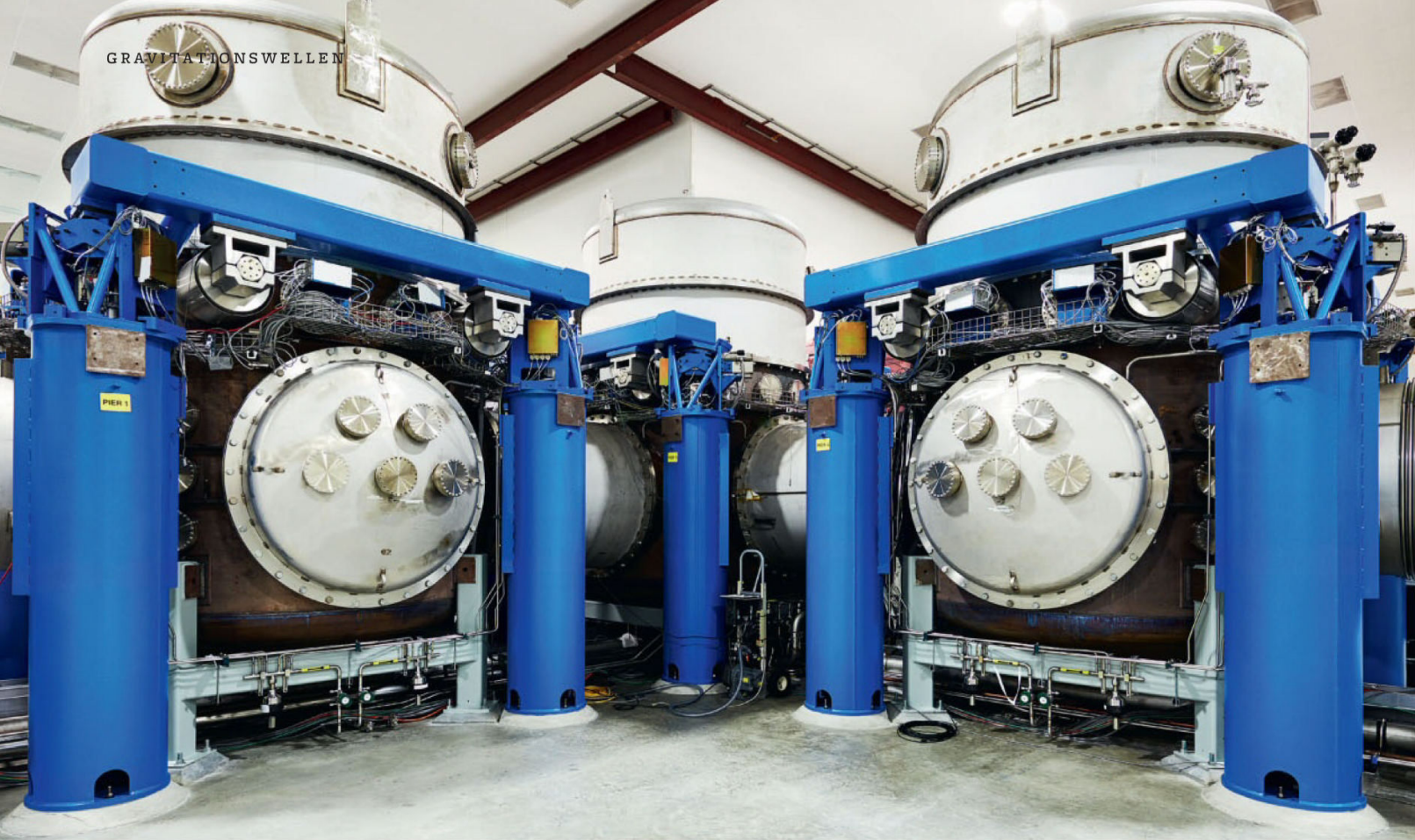
Wo sich die zwei Versuchsröhren des LIGO-Detektors kreuzen (M.), vereint eine Optik die darin verlaufenden Laserstrahlen. Durchläuft eine Gravitationswelle die Anlage, ändert sich das dabei erzeugte Lichtsignal
