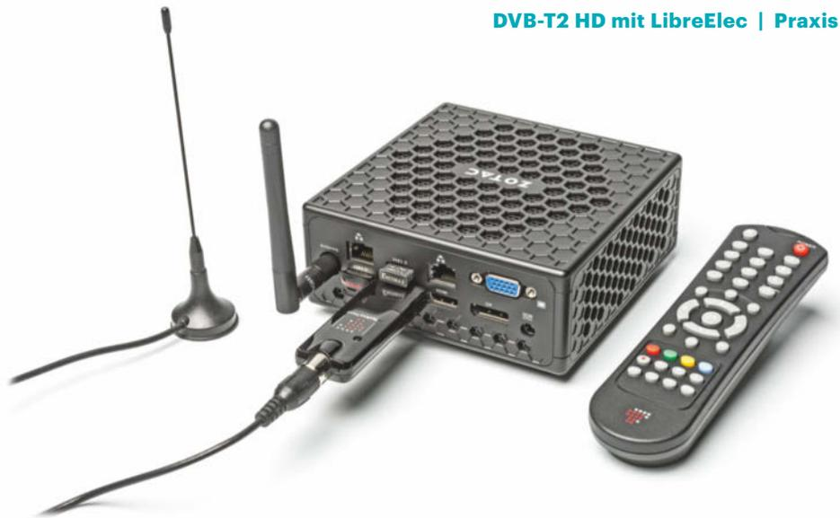
Mit einem USB-Tuner und LibreElec wird der Mini-Barebone zum DVB-T2-HD-Empfänger mit riesigem Funktionsumfang.
