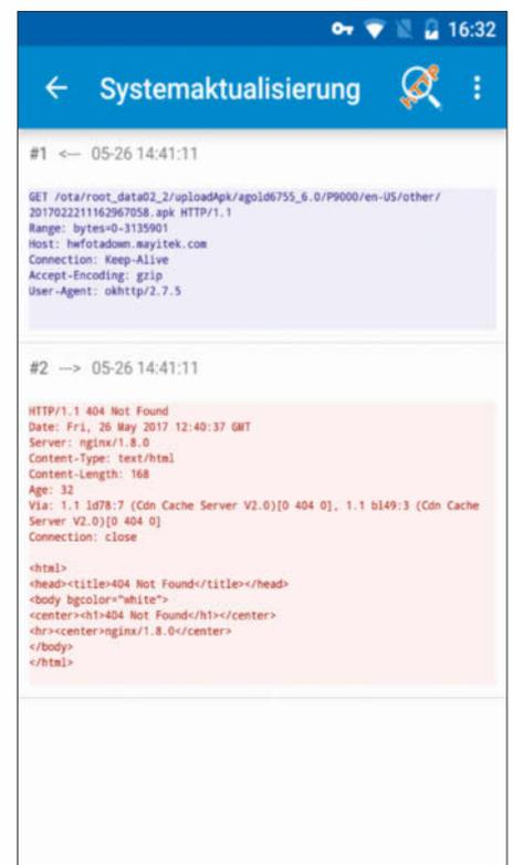
Das Update-Programm unseres Test-Smartphones hat versucht, eine APK-Installationsdatei über eine ungesicherte HTTP-Verbindung abzurufen. Das ist ein potenzielles Sicherheitsproblem.
