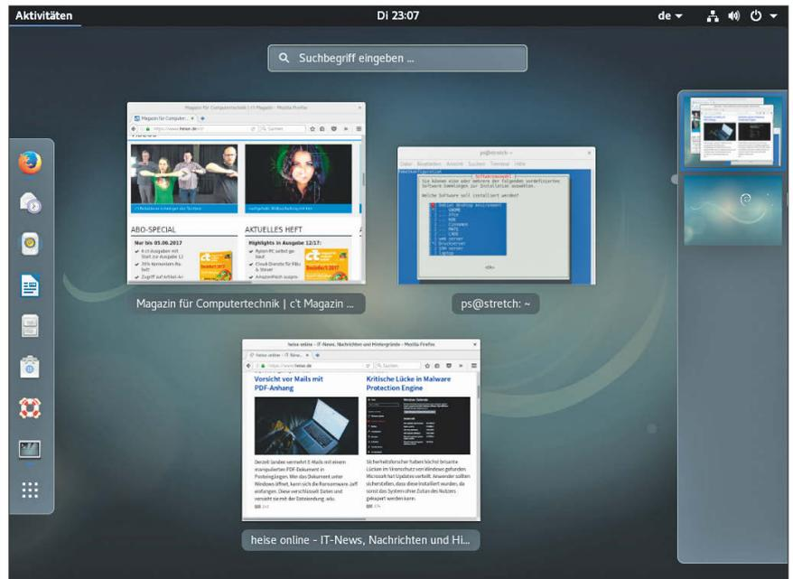
Gnome ist der Standard bei einer Desktop-Installation von Debian, muss es aber nicht sein: Der Installer lässt die Wahl und sogar die Parallelinstallation zusätzlicher Umgebungen wie KDE Plasma zu.
