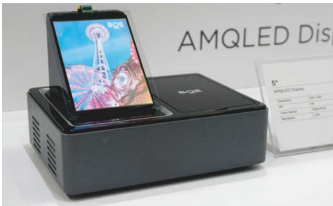
Boe zeigte ein echtes QLED mit Quantenpunkten als Pixel: immerhin 320 x 240er Auflösung im 5-Zoll-Display.
