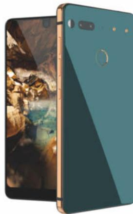
Essential schneidet für die Frontkamera ein Loch ins fast randlose Display des PH-1.
