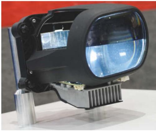
Zwischen LEDs und Linse sitzt im Scheinwerfer von Hella ein LCD, das Bereiche aus dem Fernlichtkegel gezielt ausblenden kann.
