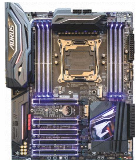
Das LGA2066-Board Gigabyte Aorus X299 Gaming 7 setzt Intels 18-Kern-Prozessor mit RGB-LEDs ins rechte Licht.
