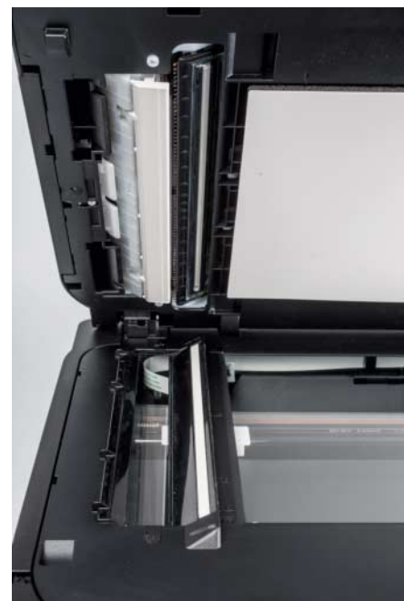
Als einziges Gerät im Test enthält der Vorlageneinzug des Canon Maxify MB5150 eine zweite Scanzeile (oben), die beim Durchzug die Rückseite des Dokuments mitscann.
