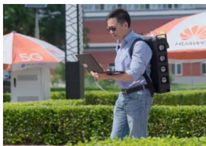
Forschung am 5G-Mobilfunk: Huawei nutzte für seinen Feldversuch Massive-MIMO und 200 MHz breite Funkkanäle.
