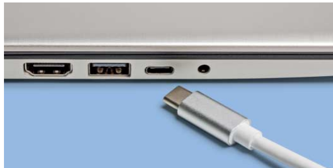
USB 3.2 soll mit bisherigen USB-Typ-C-Kabeln funktionieren.
