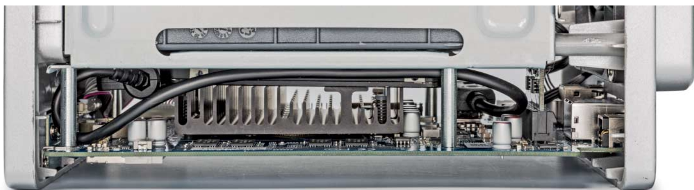
Mit einem kompakten Adapter passt die Betriebssystem-SSD zwischen Laufwerkskäfig und Platine. Über den internen USB-2-Port gingen immerhin rund 40 MByte/s.
