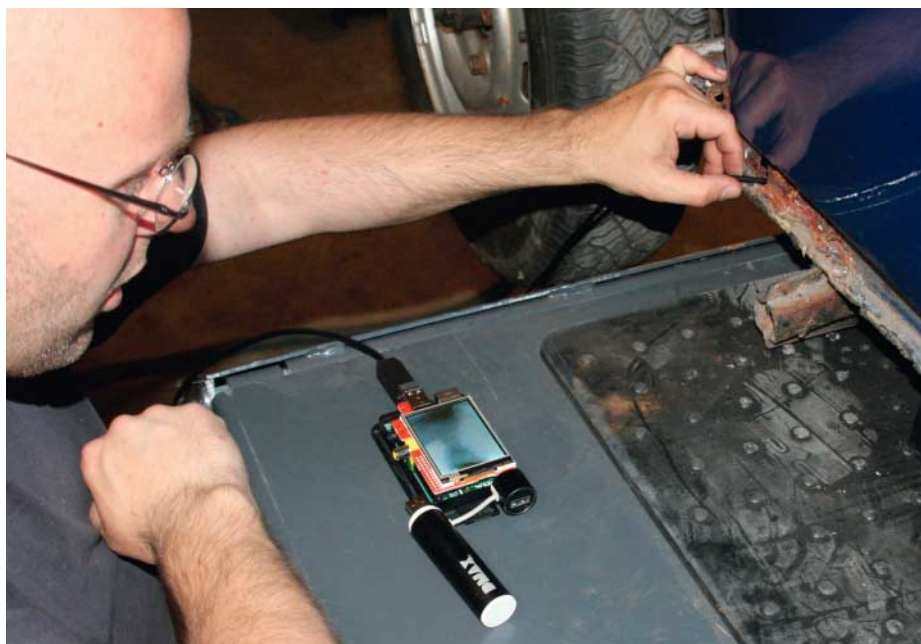
Nur oberflächlich angefressen oder durchgerostet? Mit dem Endoskop kann c't-Autor Thomas Koch den Rahmen seines VW Käfers von innen begutachten.
