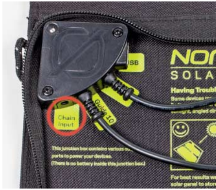
Einige Panels haben Chain-Inputs zum Verketteten weiterer Panels.
