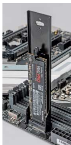
Asus spart wertvollen Platz auf dem Board, indem einer der M.2-Slots die dritte Dimension benutzt.
