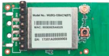
Das WUBQ-159 gibt es entweder mit Antenne oder U.FL-Buchse auf der Platine.
