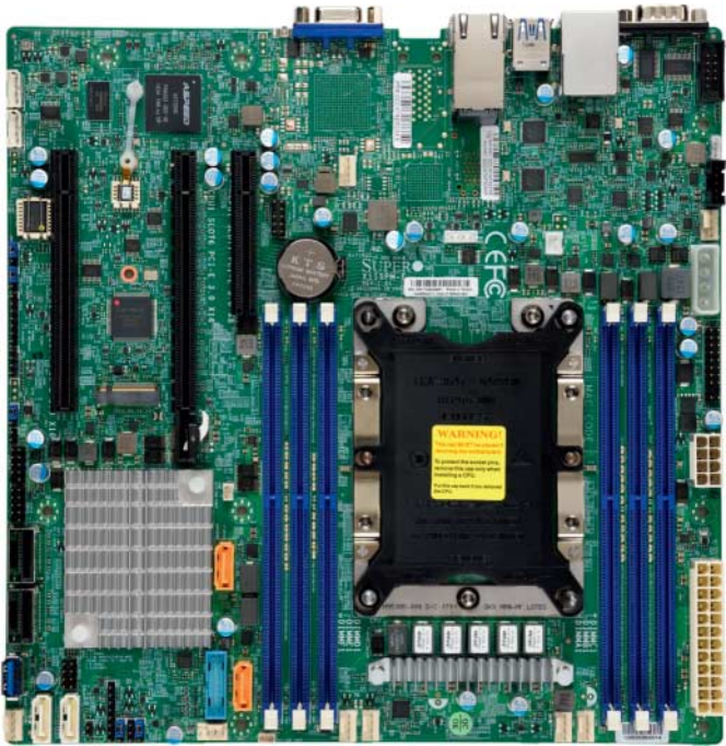
Die LGA3647-Fassung belegt viel Fläche des Supermicro X11SPM-F.
