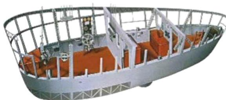
In der Führergondel steuern die Kapitäne mithilfe zweier Räder das Höhen- und das Seitenruder
