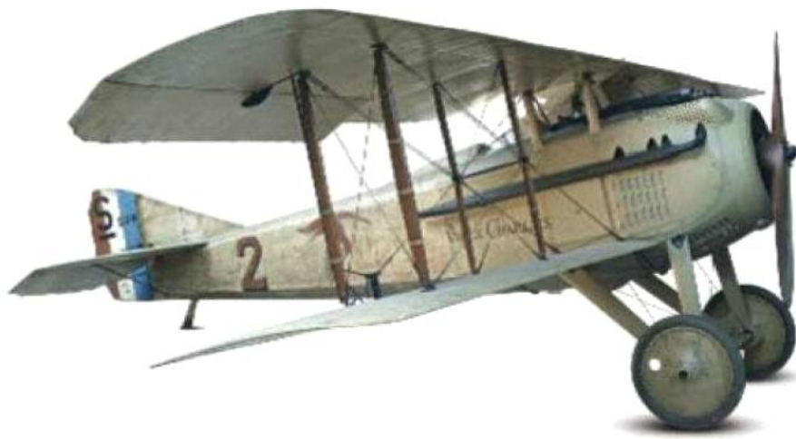
1916 FRANKREICH Die SPAD S.VII hat mit 220 PS einen besonders starken Motor; rund 6000 Maschinen des Typs werden produziert
