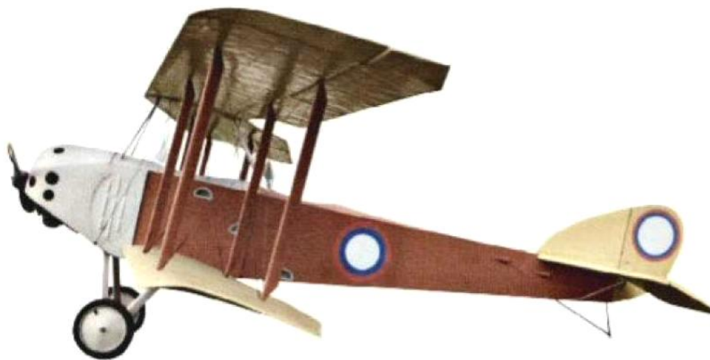
1916 RUSSLAND Ein 150-PS-Motor beschleunigt den in Odessa gefertigten zweisitzigen Aufklärer Anatra DS Anasal auf rund 145 km/h
