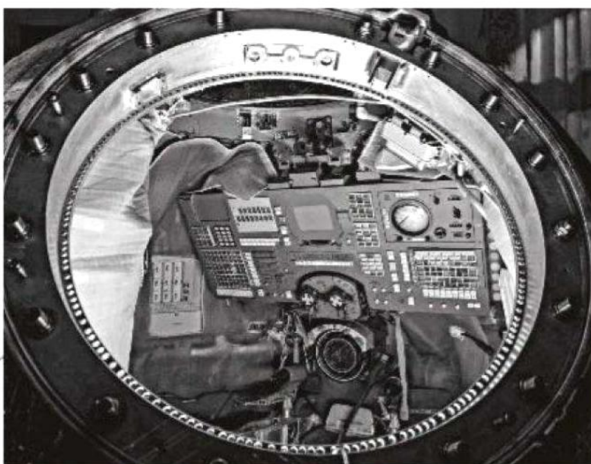
Die Kapsel verfügt nur über wenige Armaturen, denn sie wird vollständig von der Bodenstation aus gesteuert
