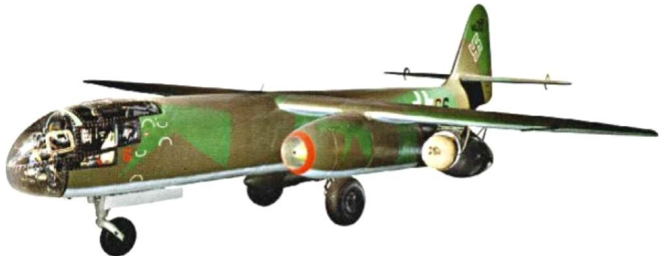
1944 DEUTSCHLAND Um Gewicht zu sparen, wirft dieser Bomber vom Typ Arado Ar 234 B-2 das Fahrgestell nach dem Start ab und landet auf Kufen – eine Technik, die sich bald als ungeeignet erweist
