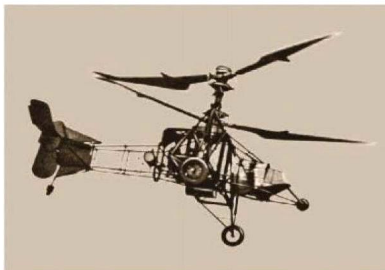
Auch wegen der beweglichen Rotorblätter liegt Breguets »Gyroplane-Laboratoire« stabil in der Luft
