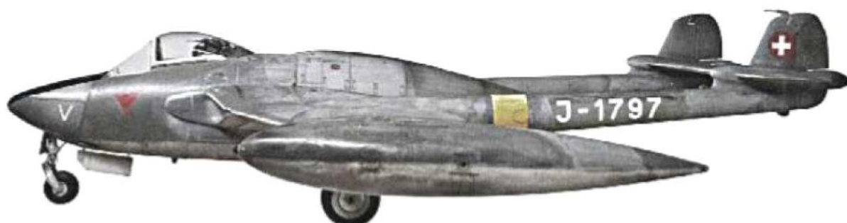
1952 GROSSBRITANNIEN Die de Havilland Venom dient als Bomber und Jäger. Für besonders lange Einsätze werden zusätzliche Tanks an den Tragflächen befestigt, die der Pilot während des Flugs ausklinken kann
