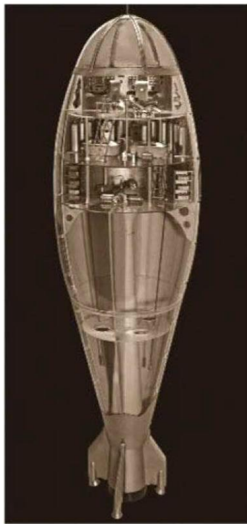
Ziolkowskij ersinnt Form und Antrieb einer Weltraumrakete (Modell nach Originalplänen)
