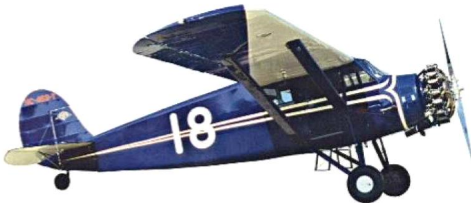
1930 USA Die Stinson Junior SM-8A besitzt nur ein Flügelpaar. Ein Konstruktionsprinzip, das den Windwiderstand reduziert – und die Reichweite deutlich erhöht
