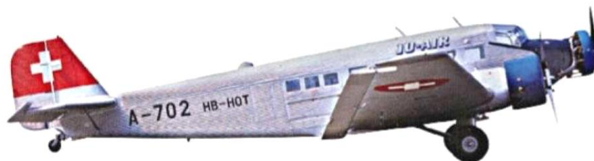
1932 DEUTSCHLAND Der Flugzeugbauer Junkers verwendet früh Komplett-Metallkonstruktionen, etwa bei der Ju 52/3m, die tausendfach eingesetzt wird – auch als Militärmaschine im Zweiten Weltkrieg
