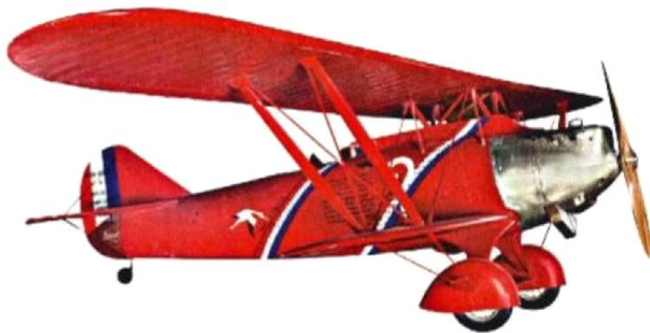
1929 FRANKREICH Der Tank der Breguet 19 TF Super Bidon, eines leichten Bombers, fasst mehr als 5000 Liter – genug Treibstoff für einen Direktflug von Paris bis an die Ostküste der USA im September 1930
