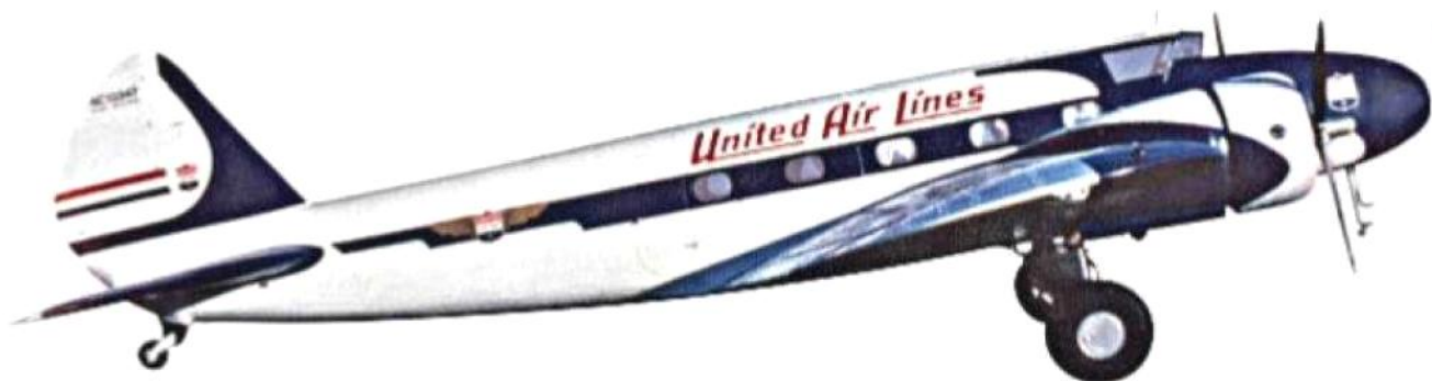
1933 USA In den 1930er Jahren prägen auch US-Konstrukteure den Markt: Das Modell 247 von Boeing hat bereits ein einklappbares Fahrwerk, eine Enteisungsanlage und einen Autopiloten
