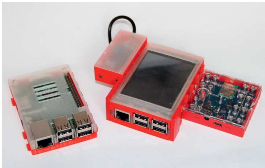
Auch mit Fischertechnik lässt sich der Raspberry Pi in einem Gehäuse unterbringen und mit dem hauseigenen TXT-Controller kombinieren.
