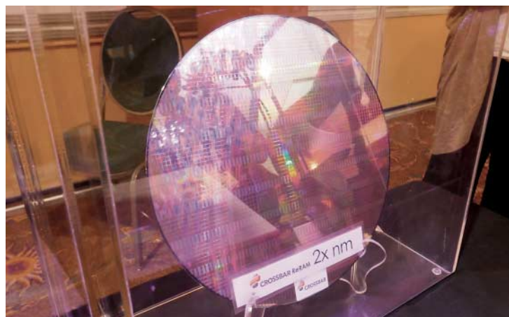
Die nächste Entwicklungsstufe von ReRAM: Crossbar schrumpft den Fertigungsprozess auf rund 20 nm.
