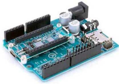
Sony Spritzer ist Arduino-kompatibel und hat GPS sowie sechs Cortex-Kerne.
