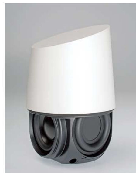
Der Verstärker von Google Home befeuert einen frontal abstrahlenden 2-Zoll-Lautsprecher. Zwei Passivradiatoren schwingen für eine bessere Bassausbeute seitlich mit.
