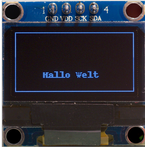
Abb. 7–9 Ein I 2 C-angesteuertes SSD1306-Modul, auf dem das Beispielskript ausgeführt wird
