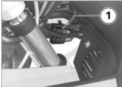
Über die vierpolige Steckverbindung **1** können z. B. aktive Lautsprecher oder kabelgebundene Kommunikationssysteme an das Audiosystem angeschlossen werden. Bitte informieren Sie sich im Fachhandel über mögliche Adapterkabel, um die von Ihnen gewünschten Komponenten zu verbinden.
