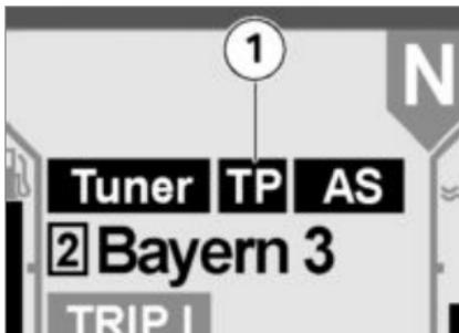
Ist die Verkehrsfunk-Funktion eingeschaltet und mindestens ein Sender mit Verkehrsfunk emp-
