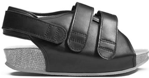
Abb. 1.15 Hallux-valgus-Nachbehandlungsschuh (Dynamics Hallux-valgus-Schuh, Fa. OFA) mit Mittelfußabrollwiege, Klettverschlüssen und tendenziell Negativabsatz zur Vorfußentlastung
