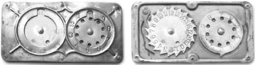
Abb. 1.7 Mechanischer Taschenrechner von A. M. Stephenson, links mit montierter und rechts ohne Deckplatte. (© Reinhard Atzbach)
