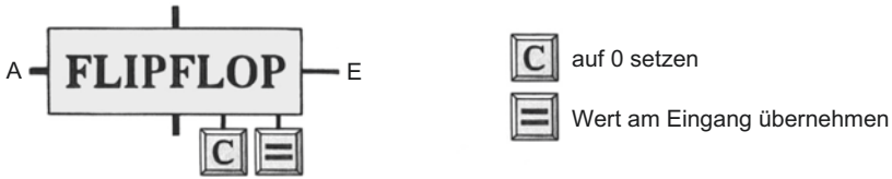
Abb. 2.33 Flipflop – das elementare digitale Speicherelement. (© Susanne Staubli, Eckart Zitzler)
