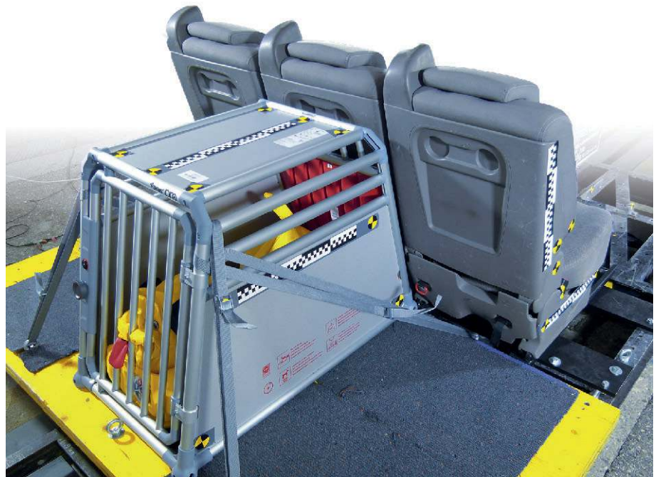
Sicher montiert. Die 4pets-Box hat ein stabiles Gehäuse aus Alu und lässt sich mit mitgelieferten Gurten eng an die Rückbank zurren. Je näher dran, desto besser der Schutz.
