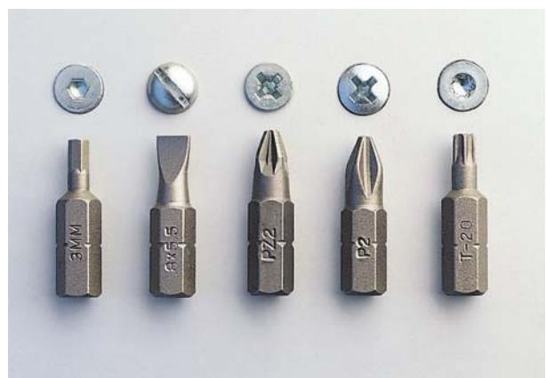
Schraubenprofile, von links nach rechts: Innensechskant, Schlitz, Pozidriv®, Philips®, Innensechsrand.
