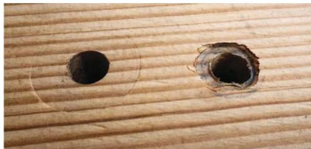
Mit der kleinen Unterlegscheibe ist die Flächenpressung zu hoch.
