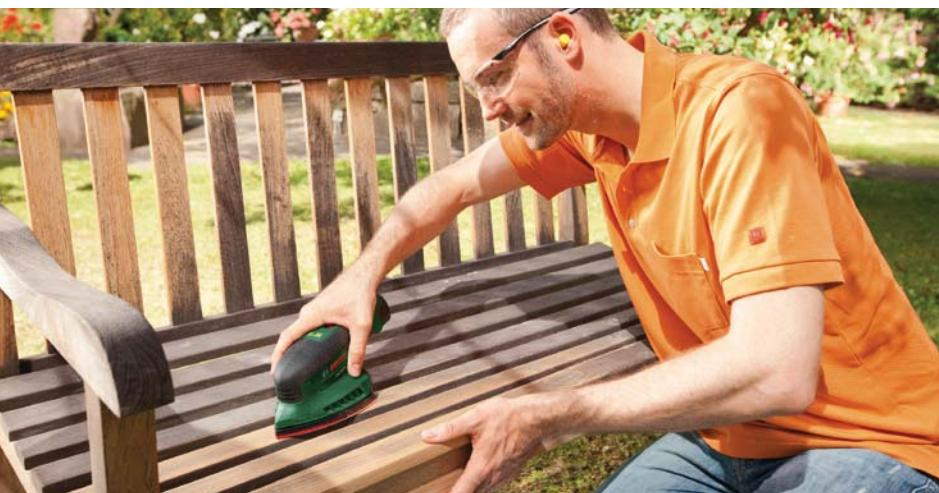
Der Multischleifer ermöglicht den Feinschliff vor dem Farbauftrag.
