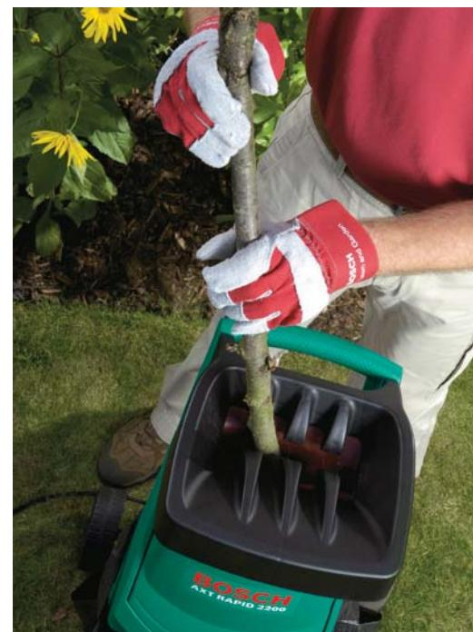
Der profilierte Einführtrichter vermindert das Hin- und Herschlagen des Häckselguts.
