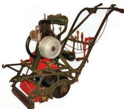
Der erste in Serie gefertigte motorbetriebene Spindelmäher von ATCO aus dem Jahr 1921. Beachtlich ist das mitgeführte „Bordwerkzeug“.
