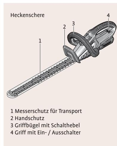
Aufbau einer elektrischen Heckenschere.
