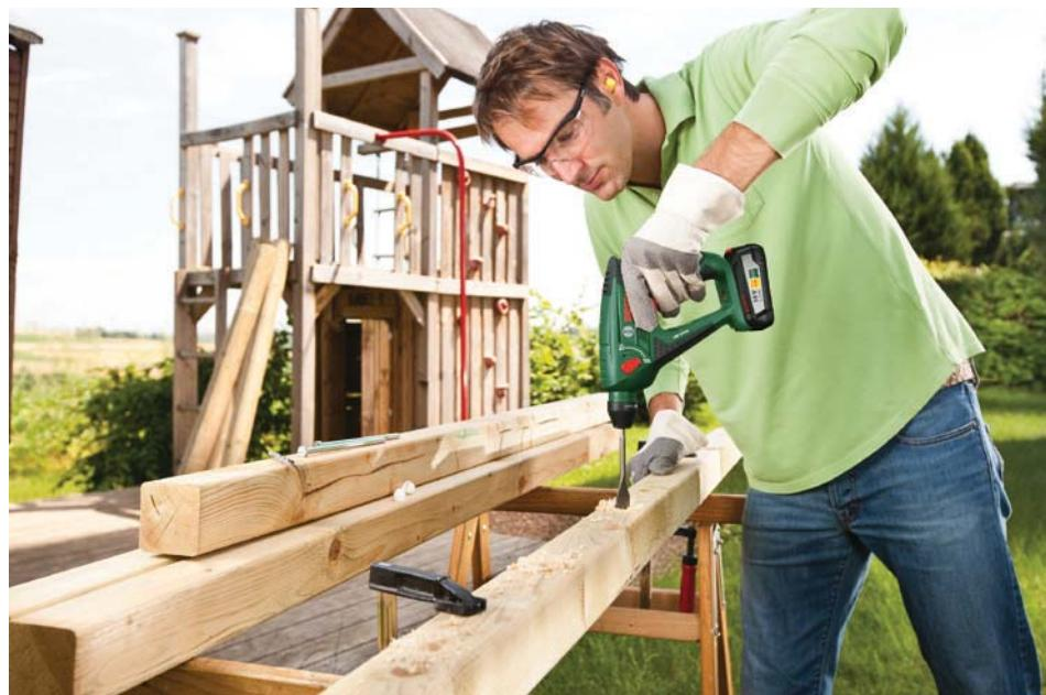
Wenn man den Schlag abschaltet, kann man mit dem Gerät auch bohren.
