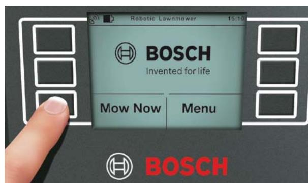
Bedienpanel des Mähroboters.
