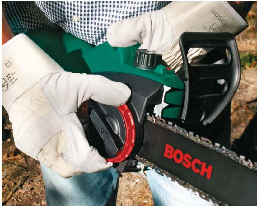
Einstellen der Kettenspannung.
