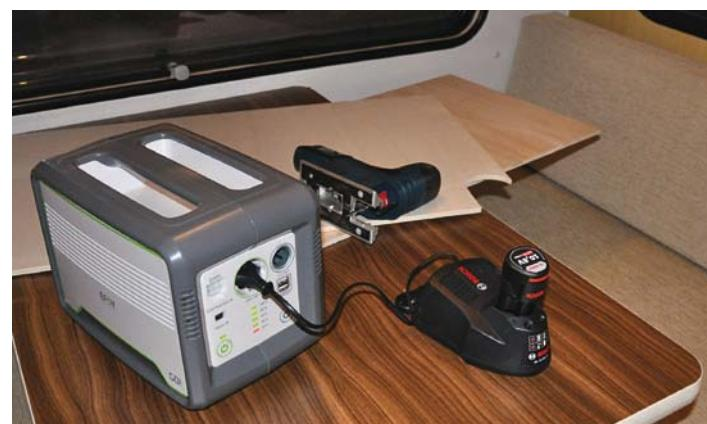
Betrieb eines Ladegeräts an einem Netzersatzgerät.
