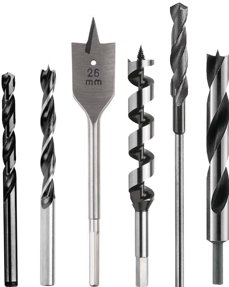
Von links nach rechts: Spiralbohrer für Metall, Spiralbohrer für Holz mit Zentrierspitze, Flachfräsböhrer, Schlangenbohrer, Schalungsbohrer, Bohrer mit abgedrehtem Schaft.
