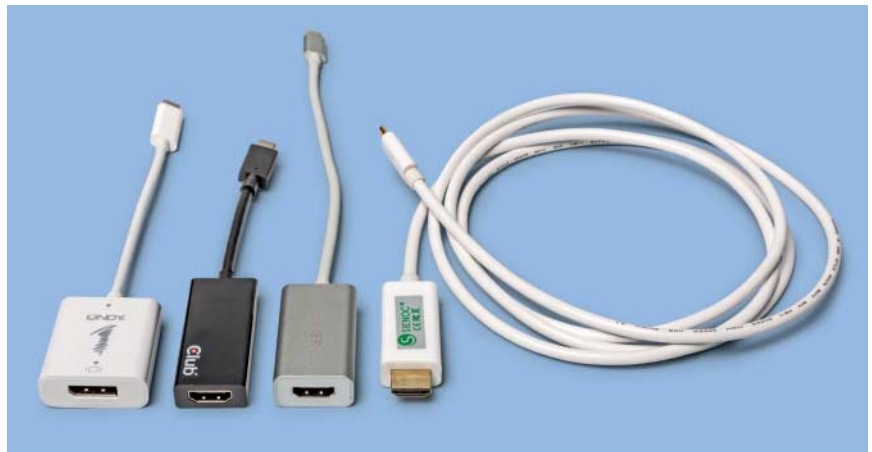
Dem Kabeladapter von Siemac (rechts) sieht man nicht an, dass er einen aktiven Chip integriert, um die DP-Signale ins HDMI-Format zu wandeln.
