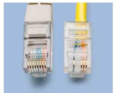
Gigabit-Ethernet braucht vier Adernpaare – manche billigen Patch-Kabel enthalten aber nur zwei, was nur für Standard- und Fast-Ethernet genügt (10 MBit/s, 100 MBit/s).
