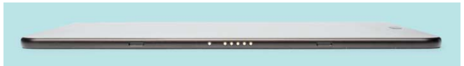
Das Samsung Galaxy Tab S3 ist trotz High-End-Hardware gerade mal 6 Millimeter dick. Die Pogo-Pins an der Seite dienen zum Anschluss der optionalen Tastatur.
