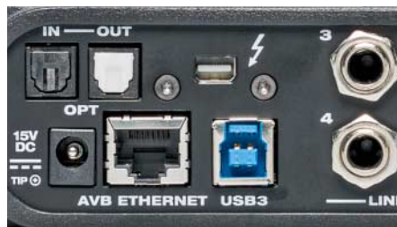
Das MOTU 624 streamt per AVB bis zu 16 Audio-Kanäle über seine LAN-Buchse.
