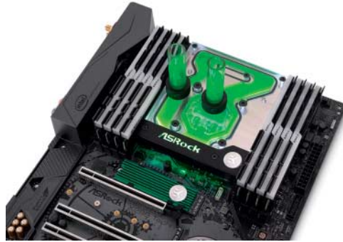
Die Monoblock-Kühler von EK Water Blocks kühlen Board und Prozessor gleichermaßen.
