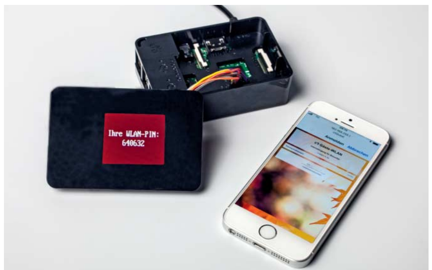
Ein kleines TFT-Display für unter 10 Euro zeigt für jeden Gast eine individuelle PIN an. Das erschwert es Nachbarn und Passanten, das Gäste-WLAN zu missbrauchen.
