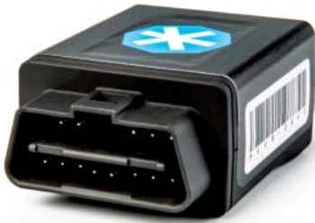
Den Tanktaler-Dongle steckt man in die Diagnoseschnittstelle des Autos.
