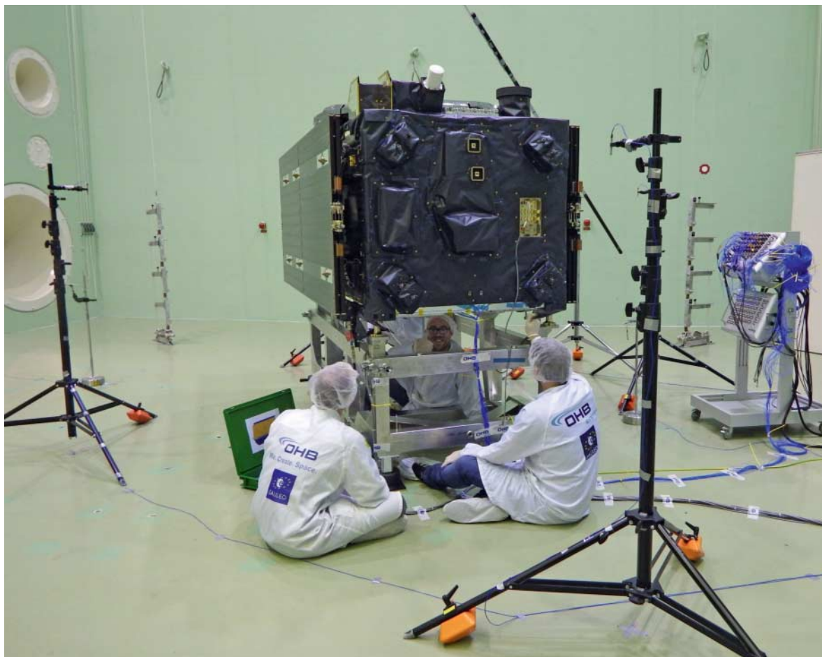
Ein Galileo-Satellit wird im Akustiklabor LEAF zum Test aufgebaut.
