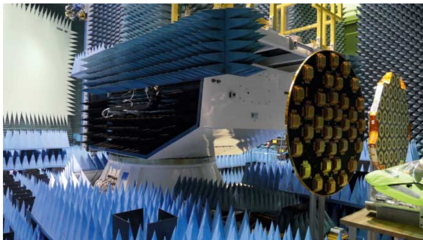
In der Testhalle können Antennen für bis zu 110 Gigahertz vermessen werden. Im Vordergrund hängen zwei Versionen der Galileo-Antennen.
