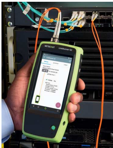
Der Netzwerktester Netscout LinkRunner G2 läuft mit einer Android-basierten Firmware und lässt sich mit Apps funktional erweitern.
