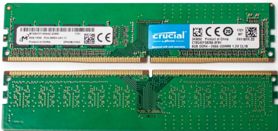
Die Crucial-Riegel CT8G4DFS8266 gehören zu den wenigen verfügbaren Single-Rank-Modulen, die ohne XMP DDR4-2666 beherrschen.
