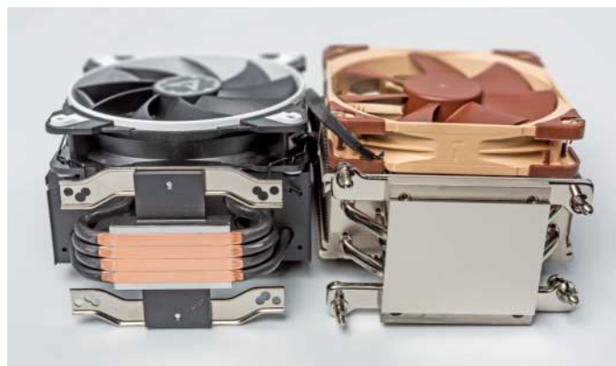
Die Grundfläche der Noctua-Kühler deckt im Unterschied zum Arctic Freezer 33 TR die gesamte CPU ab.
