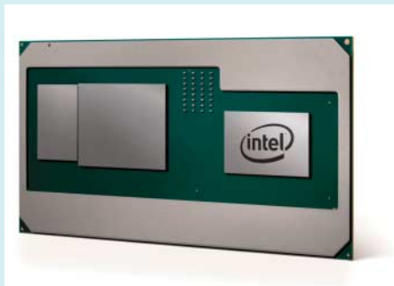
AMD und Intel kooperieren bei Notebook-Prozessoren: AMD-GPU-Die mit HBM2-RAM (links) und Intel-CPU.
