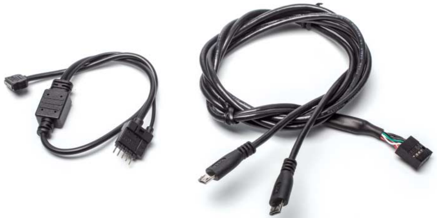
Kurze Adapterkabel (links) verbinden RGB-LED-Strips mit Mainboard-Pfostensteckern; das rechte passt auf 9-polige USB-2.0-Stiftleisten und ist für RGB-LED-Controller gedacht.
