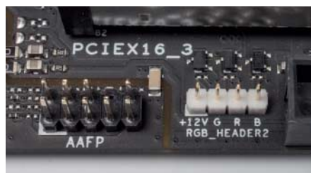
Viele Mainboards besitzen Pfostenstecker für RGB-LED-Streifen, die es in unterschiedlichen Ausführungen gibt: RGB (links, weiß), RGBW (ganz rechts) sowie mit digitaler Ansteuerung. Die Reihenfolge GRB ist üblich.
