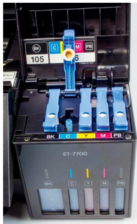
Eine mechanische Kodierung verhindert, dass man die Tanks des Epson Ecotank ET-7700 mit einer falschen Tinte befüllt.
