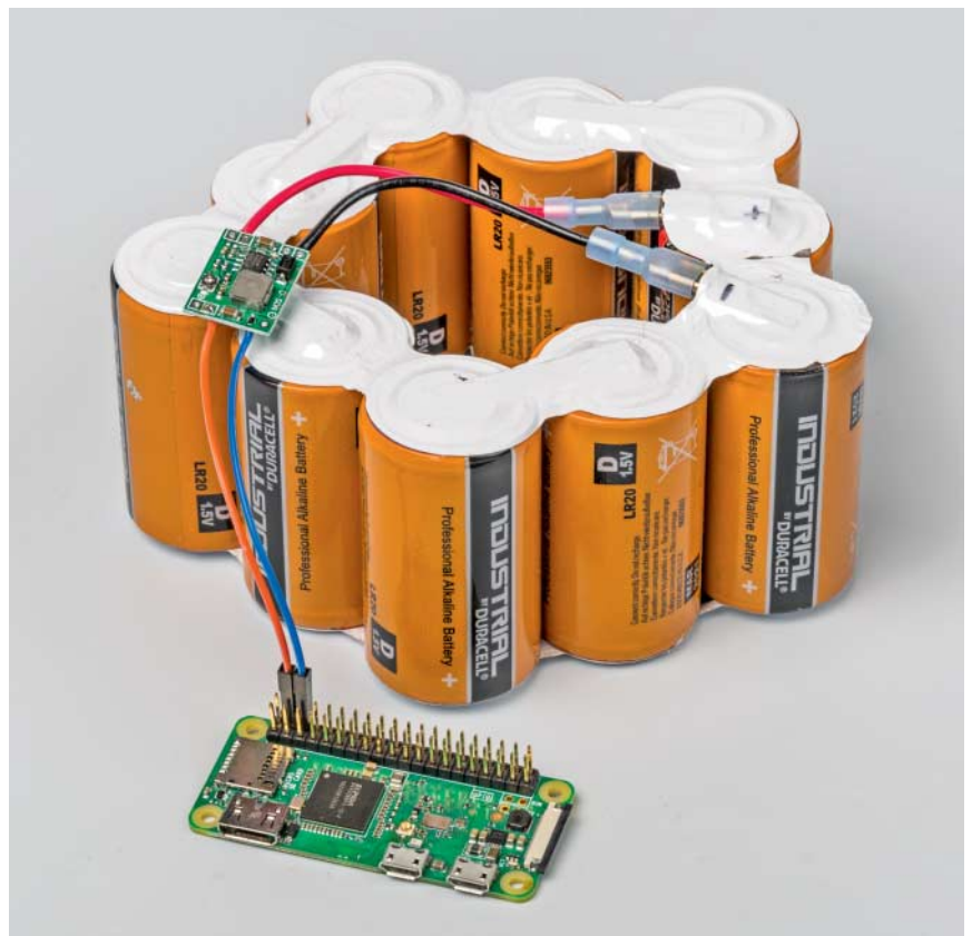
Der Zusammenbau des Flugblatts ist trivial: Ein Spannungswandler zwischen Batterie und Raspi sorgt dafür, dass die Batterie bis fast zum letzten Elektron entladen wird.
