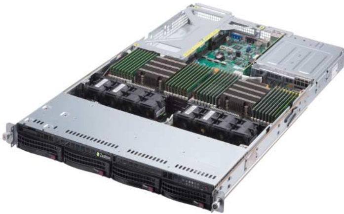
Blick in den geöffneten Starline-Server Zealbox Z80.11-4R1 mit zwei AMD Epyc und bis zu 4 TByte RAM
