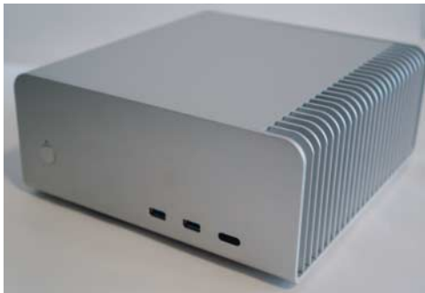
Die gefrästen Aluminiumgehäuse der uSpace-Server sollen für ausreichende passive Kühlung sorgen.
