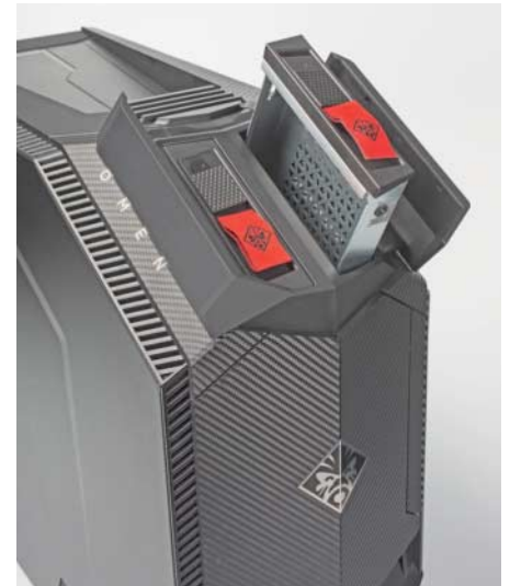
Via Schnellwechselrahmen schiebt man bei den Gaming-PCs zusätzlichen Speicherplatz nach.
