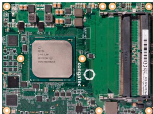
Das erste Typ-7-Modul Conga-B7XD führt zwei 10GbE-Ports heraus.
