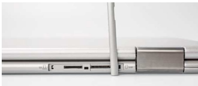
SIM- und MicroSD-Karten verschwinden hinter einer Klappe, an die man bei hochgeklapptem Deckel nicht herankommt.
