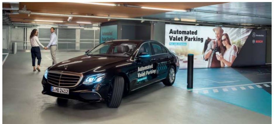
Im automatisierten Parkhaus von Bosch wird das Fahrzeug vom Parkhaus-Server in die passende Lücke dirigiert.
