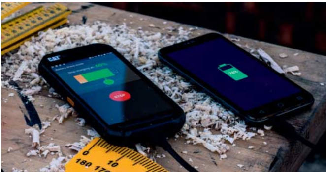
Der 5000-mAh-Akku des Cat S41 lädt per OTG-Kabel auch andere Geräte.
