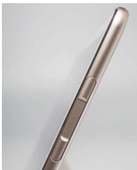
Die unscheinbare Fläche zwischen den Lautstärketasten ist ein Fingerabdruckleser für Windows Hello.
