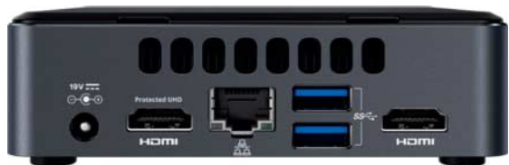
Intels neue Mini-PCs steuern mit HDMI-2.0-Buchsen zwei 4K-Displays mit 60 Hz an.
