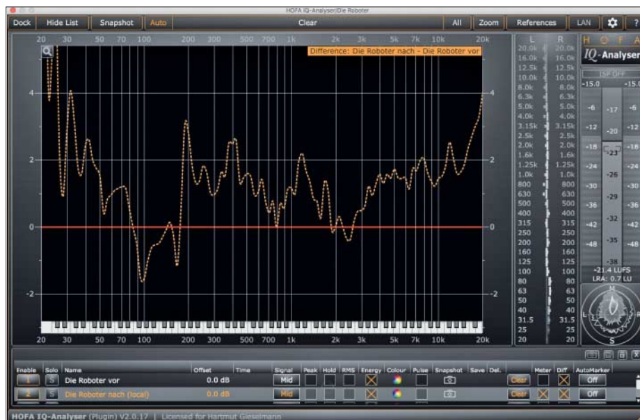
Ein Limiter kann den Frequenzgang erheblich verändern. Der Hofa IQ-Analyser zeigt Unterschiede vor (rote Linie) und nach der Bearbeitung (orange Linie).
