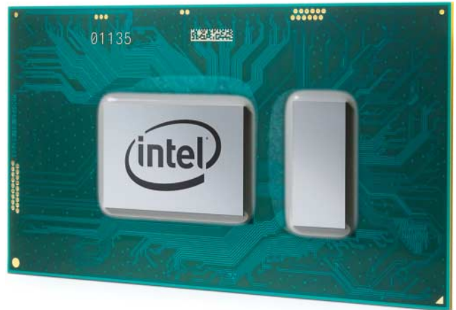
Core i7-8650U ist Intels erster Quad-Core mit 15 Watt TDP für flache Notebooks.
