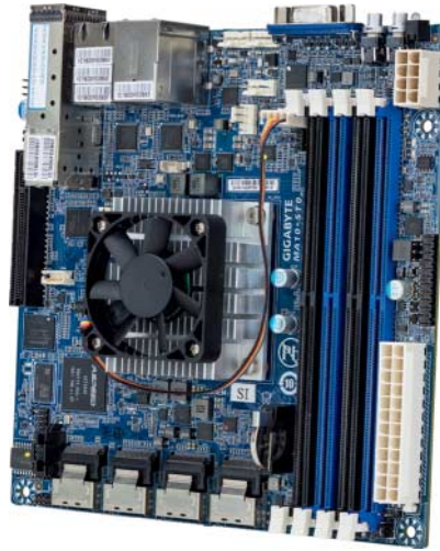
16 x86-Kerne, zweimal 10-Gigabit-Ethernet und 16 SATA-6G-Ports vereint das Gigabyte MA10-ST0 mit Atom C3958.
