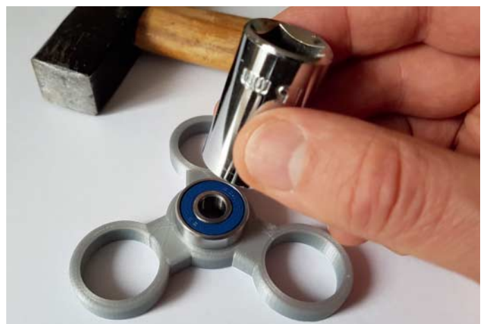
Mit Hammer und Nuss klopft man die Kugellager vorsichtig in die Halterungen.
