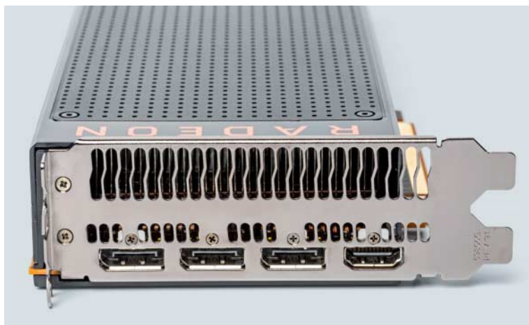
Für Monitore mit 4K- und 5K-Auflösung hat die Radeon RX Vega drei DisplayPorts 1.4 und einmal HDMI 2.0.
