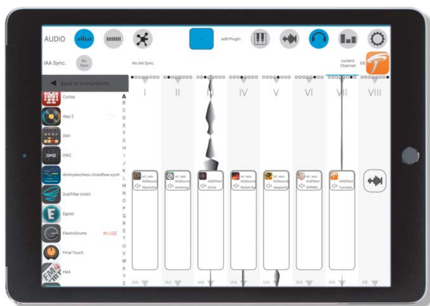
Studiomux verbindet über Lightning-USB-Kabel iOS-Geräte mit Windows- und Mac-Rechnern. Bis zu acht iPads spielen jeweils bis zu acht Instrumente und Effekte und senden sie an eine DAW.
