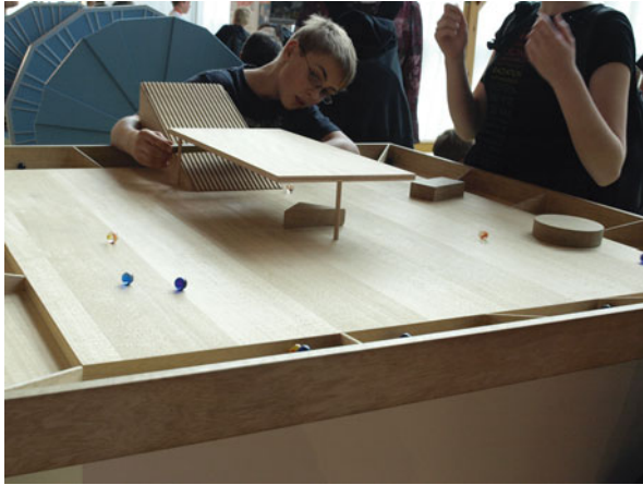
Abb. 2.5 Ein Versuch, der das Prinzip des Rutherford'schen Streuversuchs darstellt. Murmeln rollen über die Rampe gegen Holzfiguren und werden danach weggestreut. Die Form der Figur entscheidet über die Streurichtung. (Foto: © Ching-Yen Huang)
