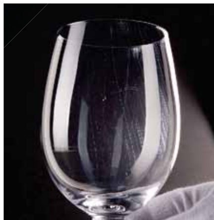
Nach dem Dauertest. Linienkorrosion bei Somat 10 und Finish All in 1 Plus.
