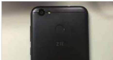
Auf der Rückseite befinden sich Kamera, Blitz und Fingerabdruckscanner. Darunter versorgt der 5.000 Milliamperestunden starke Akku das Blade A6 mit Energie.
