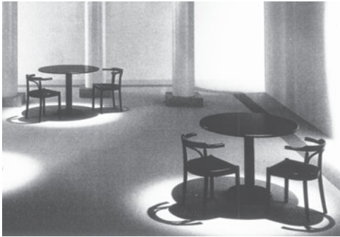
Bild 10.30: Schatten bei Zentralbeleuchtung - Lichtstudie der Siemens AG
