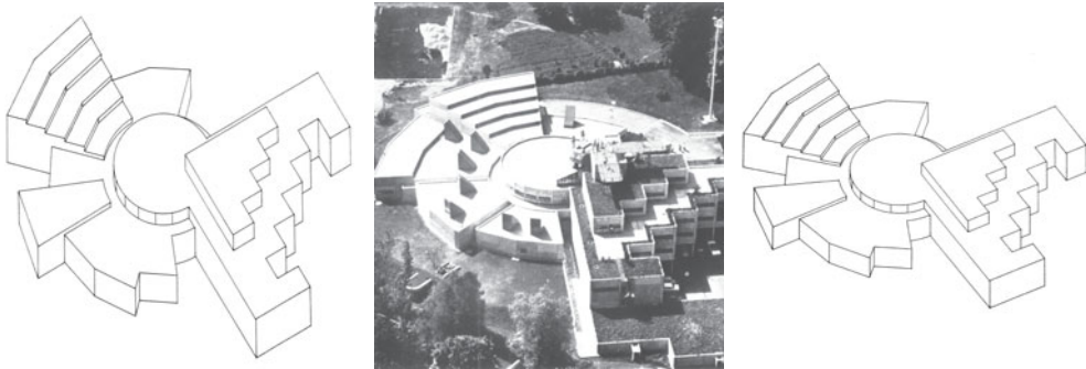
Bild 12.1: Grundrissaxonometrie (schiefe Axonometrie), Luftaufnahme und normale Axonometrie des ORF-Landesstudios, Salzburg, 1972, Gustav Peichl
