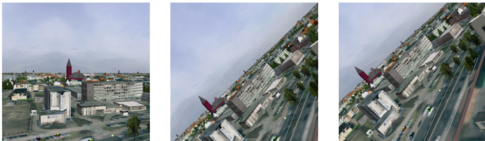
Abb. 3.29: Die Reihenfolge bei der Matrixmultiplikation spielt eine Rolle. Links ist die Startszene (Campus Süd der Hochschule Niederrhein) abgebildet, daneben ist das Resultat einer Drehung in der x - y -Ebene um 16 Grad mit anschließender Drehung in der x - z -Ebene um 44 Grad abgebildet. Zum rechten Bild führt die umgekehrte Reihenfolge der Drehungen.
