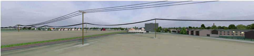
Abb. 5.7: Hochspannungsleitungen, gezeichnet mit dem Kosinushyperbolikus
