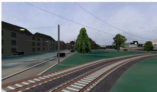
Abb. 3.14: Ausrichtung paralleler Linien: Jedes Gleis besteht aus zwölf Linien (vier Kanten des Bahndamms, vier Kanten pro Schiene), die parallel zur Oberleitung verlaufen.
