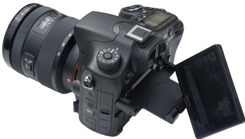
Frei bewegliche Monitore, wie hier bei der Sony Alpha SLT-A77 II, ermöglichen bequem Aufnahmen auch aus ungünstigen Perspektiven, z. B. vom Boden aus, über Menschenmengen hinweg oder sogar „um die Ecke“. [Foto: MediaNord]
