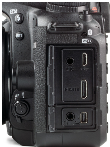
Mit Gummiklappen gegen Spritzwasser und Staub geschützte Anschlüsse einer Spiegelreflexkamera, hier am Beispiel der Nikon D7500. Im oberen Feld Mikrofon-, USB- und HDMI-Buchse. Im unteren Feld Kopfhörer- und Fernauslöser-Buchse. [Foto: MediaNord]
