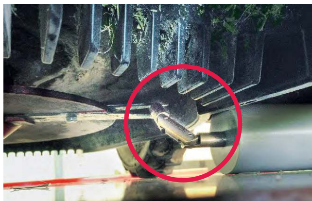
Prüffinger. Ein Kind könnte mit seinen Fingern in den Schnittbereich der Messer geraten.
