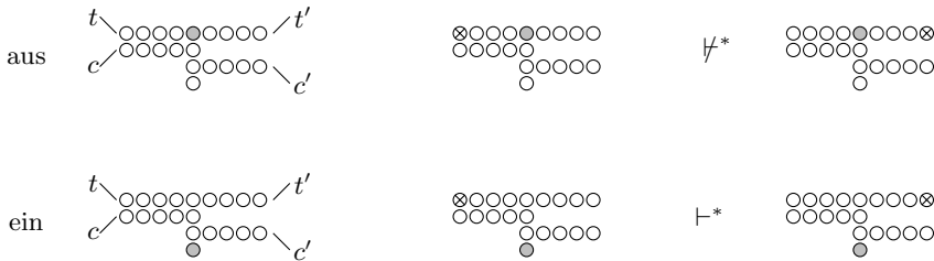
Abb. 14.56. D^r -Baustein im Zustand aus (oben) und ein (unten)
