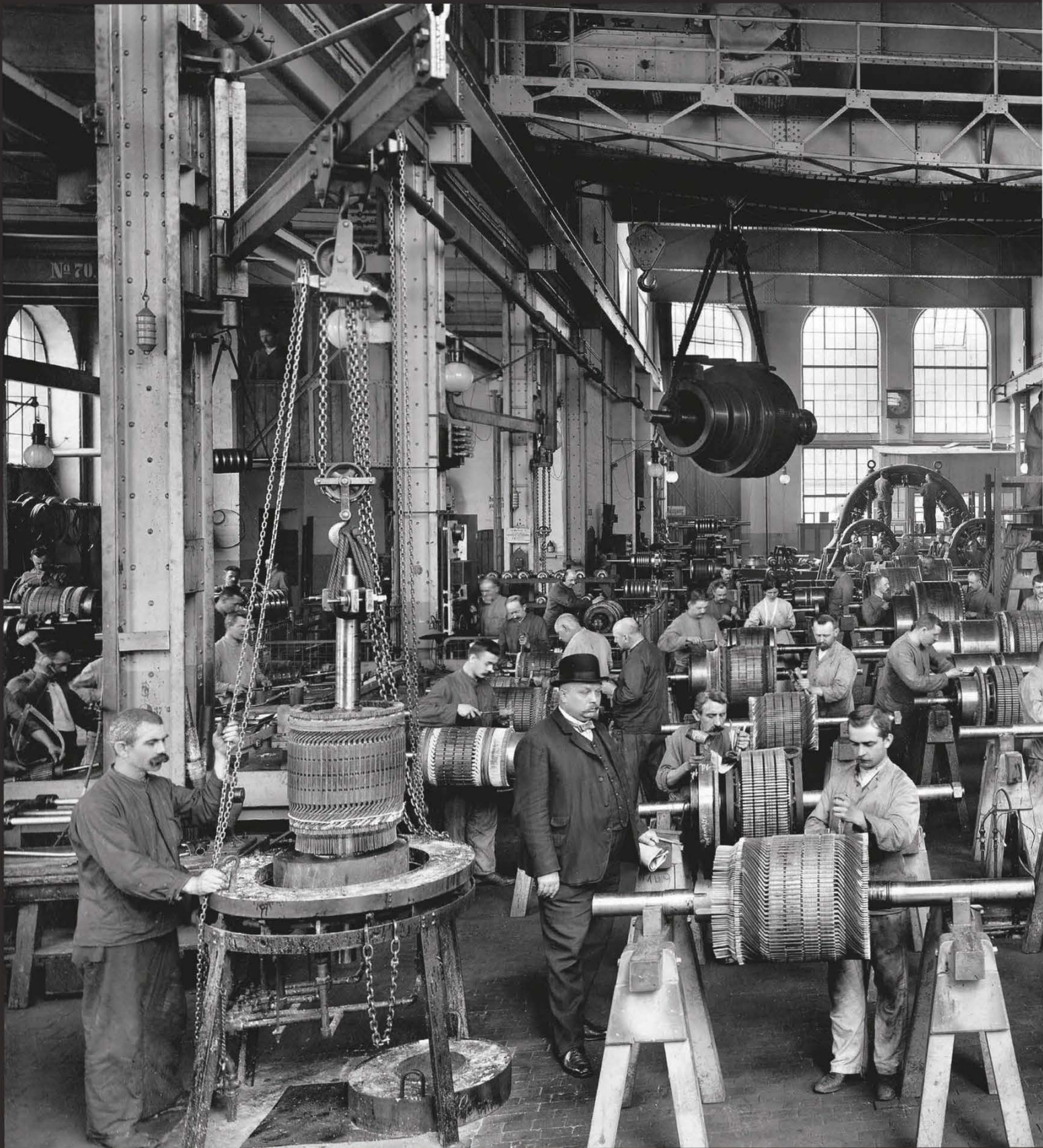
IN EINER NÜRNBERGER FABRIKHALLE fertigen Arbeiter 1910 gewaltige Spulen für elektrische Motoren und Generatoren. Die Elektroindustrie und der Maschinenbau sind Bayerns aufstrebende Branchen. Allein Nürnberg zieht so viele Arbeitskräfte an, dass um 1900 nur noch jeder neunte Bürger der Stadt auch hier geboren ist
