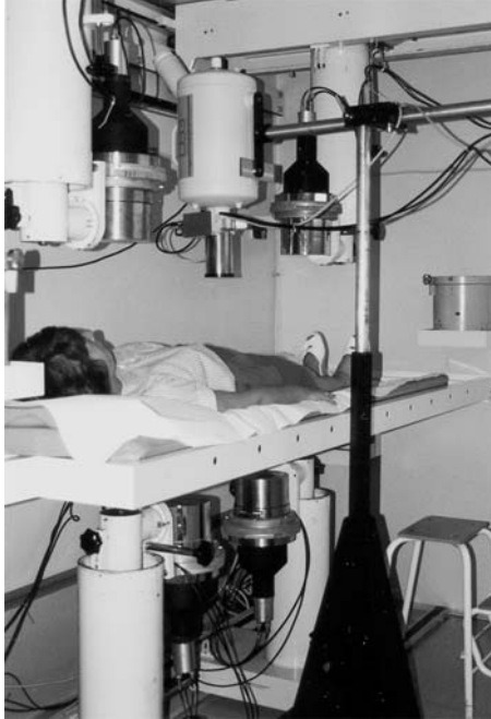
Abb. 5.36 Ganzkörperzähler mit NaI(Tl)-Detektoren und Halbleiterzähler ( http://www.strz.uni-giessen.de )
