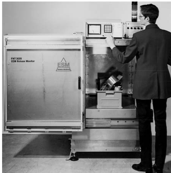
Abb. 8.5 Freigabemonitor zur Ausmessung der spezifischen Aktivität von Werkzeugen und Maschinenteilen (Typ FHT 3035 CCM Freigabemonitor, ESM Eberline Instruments GmbH)
