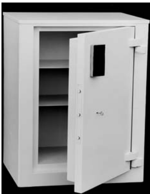
Abb. 8.3 Bleitresor zur Aufbewahrung radioaktiver Proben (JL Goslar)
