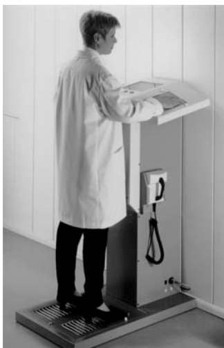
Abb. 8.8 Ganzkörper- Kontaminationsmonitor zur Messung von \alpha -, \beta - und \gamma - Kontaminationen mit einem System von Großflächenzählern (Typ RADOS RTM860TS, RADOS Technology GmbH)
