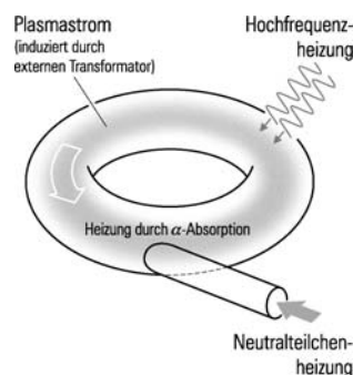
Abb. 16.14 Plasmaheizmethoden in einem Tokamak-Fusionsreaktor
