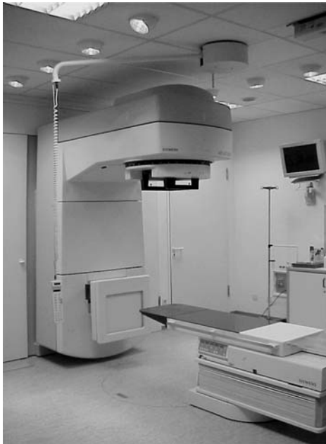
Abb. 4.6 Linearbeschleuniger, Elektronenenergie 6 bis 21 MeV mit maximalen Photonenenergien von 6 bis 21 MeV (Typ: Siemens KD-2, http://www.ma.uni-heidelberg.de )
