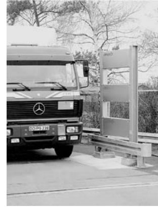
Abb. 8.13 Stationäre Radioaktivitätsmessanlage zur Kontrolle von LKWs, ausgerüstet mit Plastik-Szintillationszählern (Typ FZM 700, mab STRAHLENMESSTECHNIK)
