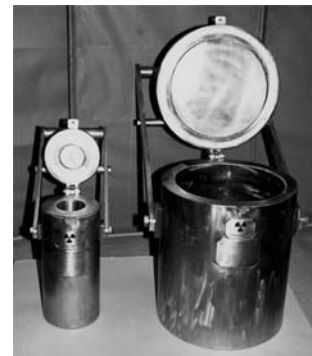
Abb. 8.11 Klapptopf mit Bleiabschirmung und Tragegestänge zum Transport von radioaktiven Proben oder Quellen (JL Goslar)
