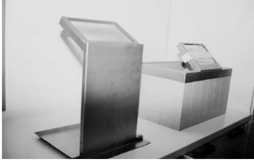
Abb. 8.1 Arbeitsplatzausrüstung: Strahlenschutz-Brustwehr mit Bleiglasfenster und Bleiburg mit Bleiglasfenster (JL Goslar)
