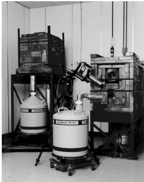
Abb. 5.22 Reinst-Germanium-Zähler zur Messung von \gamma -Strahlung. Detektoren in unterschiedlichen Kryostatkonfigurationen und Abschirmungen (EG&G)
