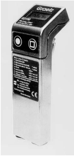
Abb. 9.3 Direkt anzeigendes Alarmdosimeter mit Dosis- und Dosisleistungswarnung (Modell ED 150, GRAETZ Strahlungsmeßtechnik GmbH)
