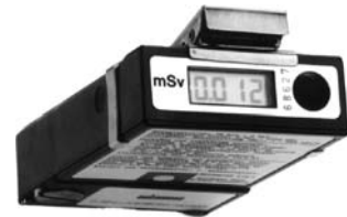
Abb. 9.2 Direkt anzeigendes Alarmsdosimeter mit Dosis- und Dosisleistungswarnung (Modell ADOS, autmess GmbH)
