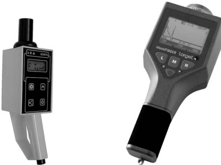
Abb. 5.17 Dosisleistungsmessgerät mit NaI-Szintillationsdetektor; Dosisleistungsmessbereich 40 nSv/h–2 mSv/h (Typ SCINTO, S.E.A. GmbH)
