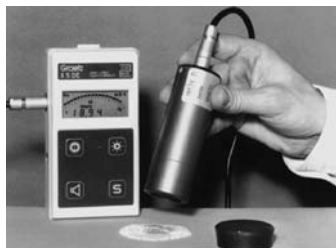
Abb. 5.15 Analog anzeigendes Strahlungs- und Kontaminationsmessgerät mit Endfenster-Geiger-Müller-Zählrohr (MINI-INSTRUMENTS LTD, Thermo Eberline Trading GmbH)
