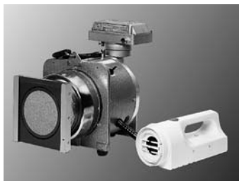
Abb. 11.4 Low-Level-Monitor-System mit Staubprobensammler zur Messung geringer Beta-Aktivitäten, z. B. im Rahmen von Radon-Filter-Messungen (Modell LLM 500, mab STRAHLENMESSTECHNIK)
