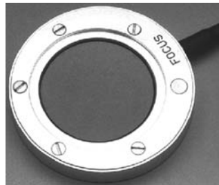
Abb. 5.2 Parallelplatten- Ionisationskammern mit Ausleseeinheit für Röntgengeräte; Messbereich 0,001–9999 Gy/cm 2 (Typ: DOSE AREA PRODUCT METER 2640A, NE Technology Ltd, Thermo Eberline Trading GmbH)
