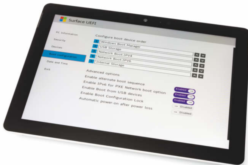
Das UEFI-BIOS erleichtert es, ein BIOS-Setup zu programmieren, das sich auch per Touch bedienen lässt, nämlich für (Windows-)Tablets ohne Tastatur.
