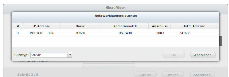
Moderne NVR-Software, hier QNAPs Surveillance Center, ermittelt benötigte Streaming-URLs einfach per ONVIF.
