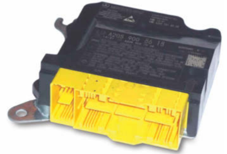
Das Airbag-Steuergerät analysiert die Bewegungsdaten des Fahrzeugs und zündet im Ernstfall die unterschiedlichen Rückhaltesysteme.
