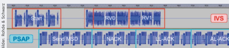
Eine akustische Aufzeichnung eines eCalls zwischen Auto (IVS) und Rettungsstelle (PSAP) würde so aussehen.
